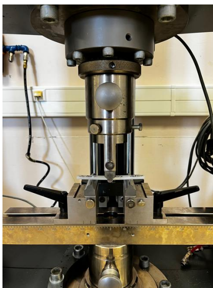
Figura 32 - Equipamento utilizado no Ensaio de Flexão
