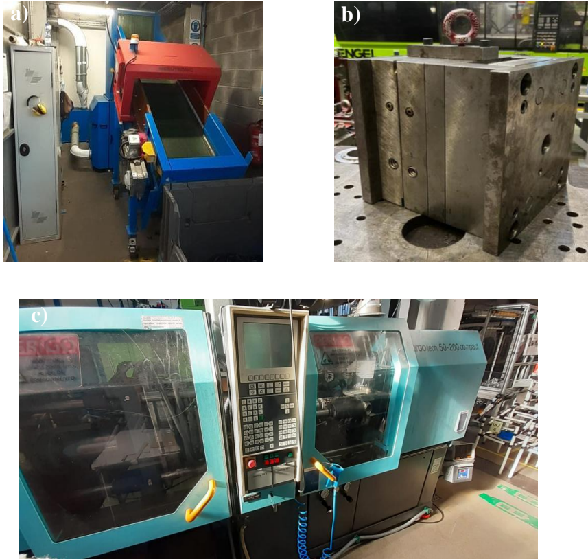
Figura 28 - Equipamentos utilizados: a) Moinho industrial; b) Molde de injeção de provetes da ESTG; c) Máquina de injeção de 50 Toneladas
