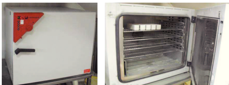
Figura 25 – Estufa a 105°C para secagem dos provetes.
