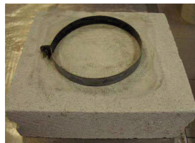
Figura 30 – Molde para realização de provete para ensaio de permeabilidade ao vapor.
