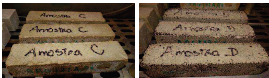
Figura 60 – Provetes das amostras C e amostra com granulado de cortiça (identificada como amostra D).
