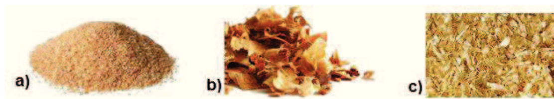
Figura 13 - Tipo de resíduos de madeira. a) Resíduo da serragem (GetDomainVids.com, 2013); b) Cepilho / Maravalha (Alibaba.com, 2013); c) Aparas de madeira.
