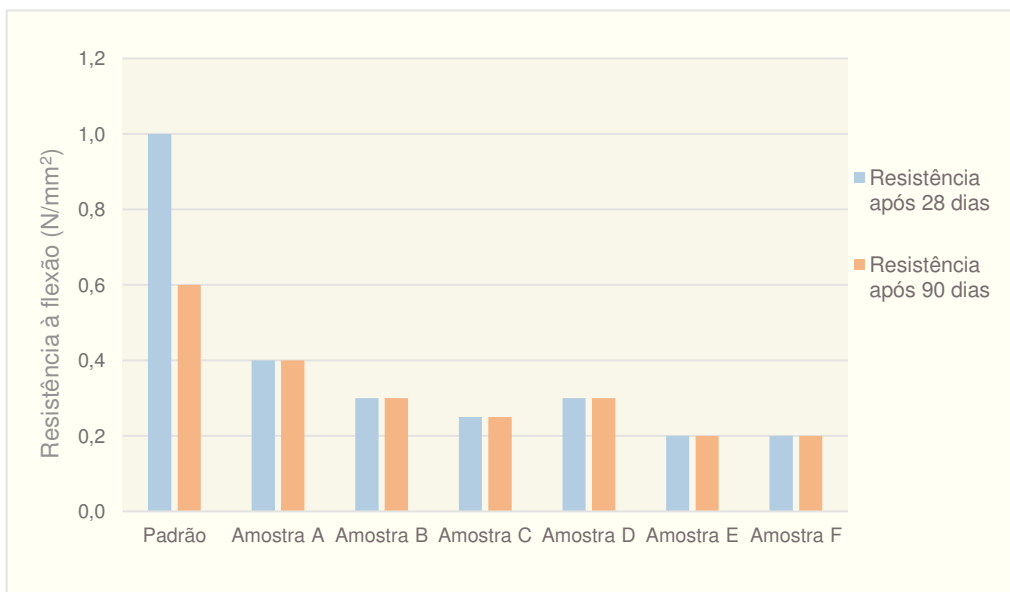
Figura 48 - Resultados da resistência à flexão, após 28 e 90 dias, para as amostras de ensaio.
