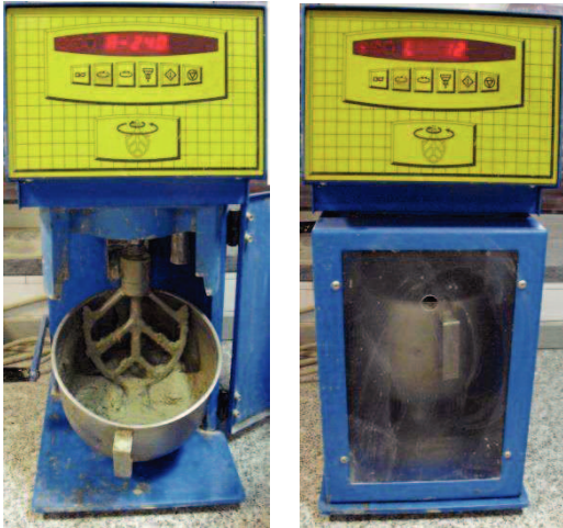
Figura 19 - Mistura mecânica da argamassa com água.
