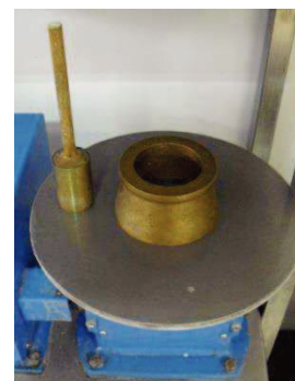
Figura 18 – Mesa de espalhamento e molde cônico.
