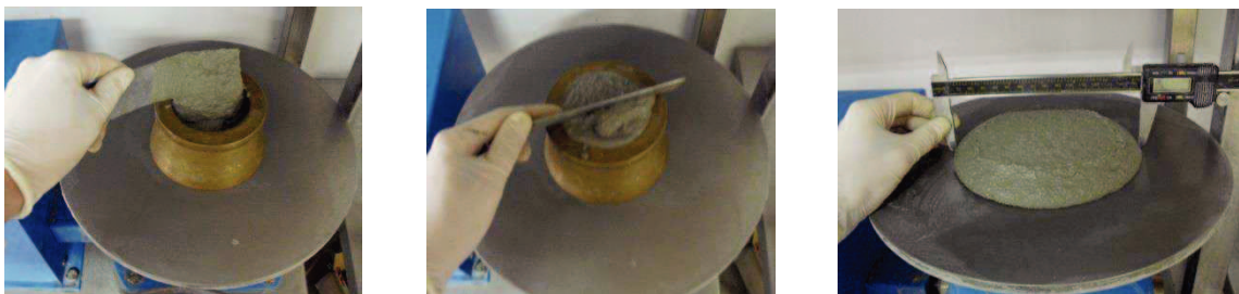
Figura 20 – Realização do ensaio de espalhamento da argamassa.
