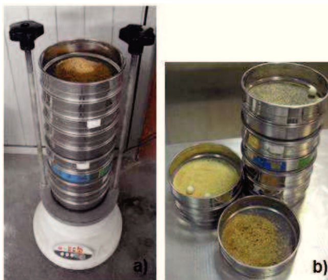
Figura 16 – Montagem dos peneiros: a) coluna de peneiros; b) distribuição do resíduo após peneiração.
