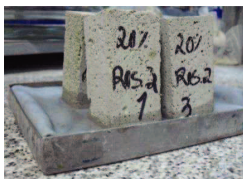
Figura 29 – Provetes imersos em água.
