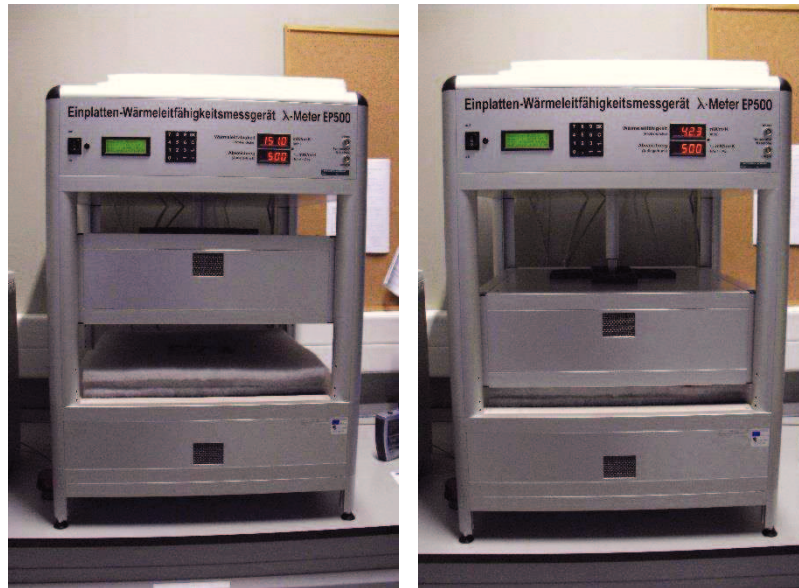
Figura 45 – Realização de ensaio de condutibilidade térmica no equipamento \lambda -Meter EP500e.
