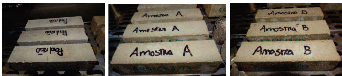
Figura 59 – Provetes das amostras A, B e C após 15 ciclos gelo-degelo.
