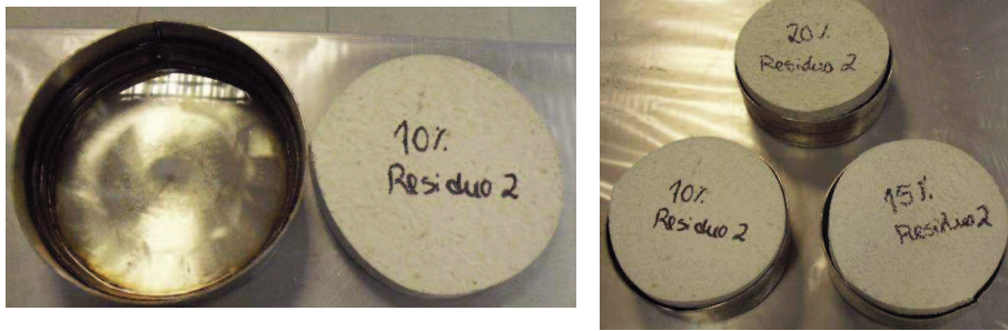
Figura 31 – Colocação de provetes em copos circulares contendo solução de \text{KNO}_3 .
