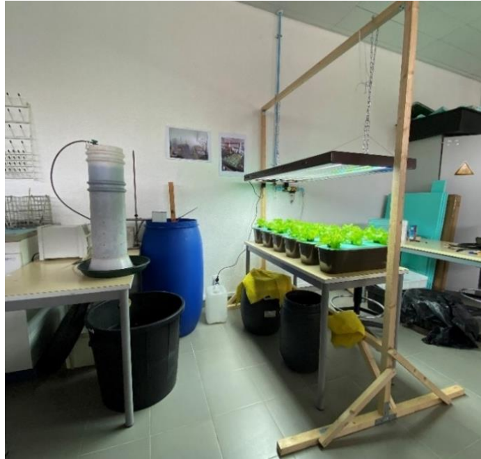
Figura 3.9. Sistema utilizado no tratamento de água residual suinícola através de vermifiltração e hidroponia.
