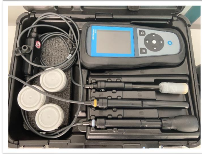
Figura 20 - Sonda multiparamétrica com medição de salinidade, saturação de oxigénio e pH
