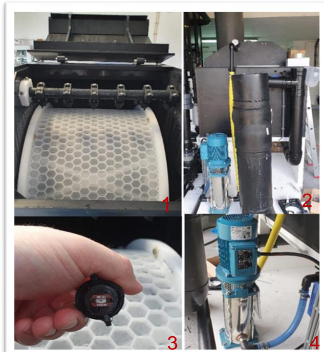
Figura 12 - Filtro de tambor. (1) tambor filtrante; (2) visão lateral do conjunto do biofiltro; (3) botão que permite ligar e desligar ou meter em automático o equipamento; (4) bomba que faz o filtro de tambor funcionar.
