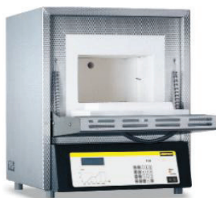
Figura 2.1 – Mufla elétrica para incineração de amostras [22] .
