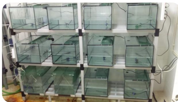
Figura 2.3.1 – Aquários isolados utilizados no ensaio para cálculo do LD 50 em Argyrosomus regius .
