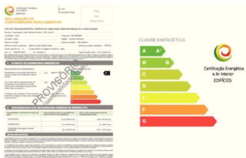
Figura 1 – Modelo de Certificado Energético de Edifício e respectiva classificação energética
