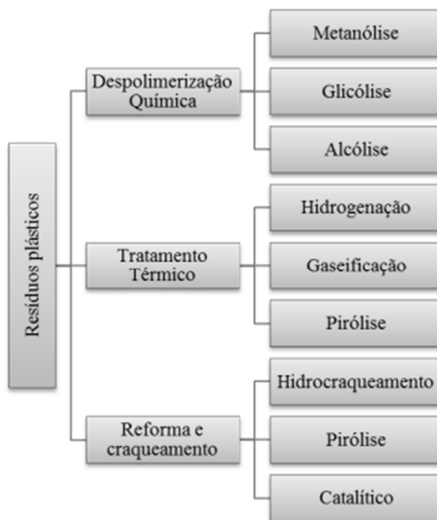
Figura 15 – Esquema dos processos da reciclagem química dos resíduos plásticos (Adaptado de: Pinto & et al., 2012).
