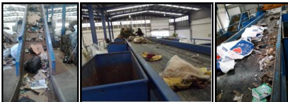
Figura 20 – Triagem dos resíduos por separação manual.
