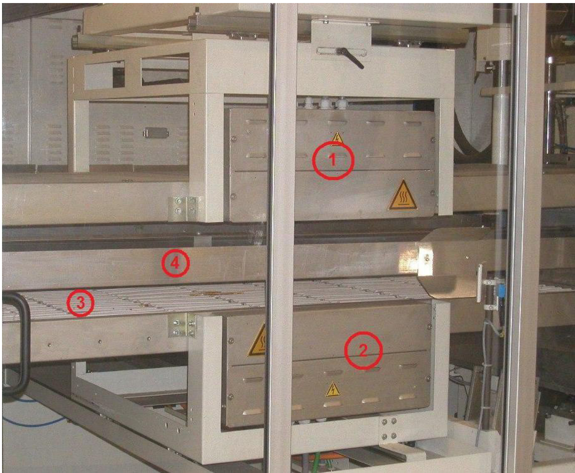
Figura 2.32 - Estação de aquecimento e seus componentes
