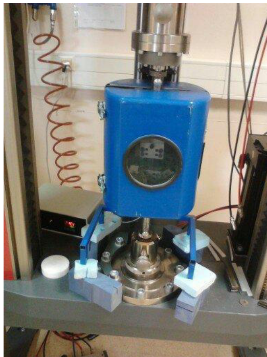
Figura 3.10 - Câmara ambiental utilizados nos ensaios de tração com diferentes temperaturas de ensaio
