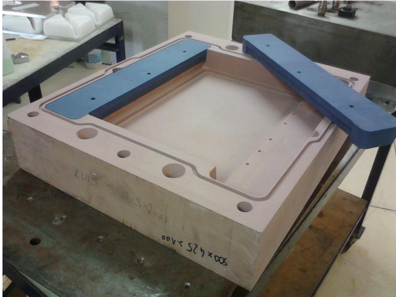
Figura 3.13 - Aspeto do molde após maquinação
