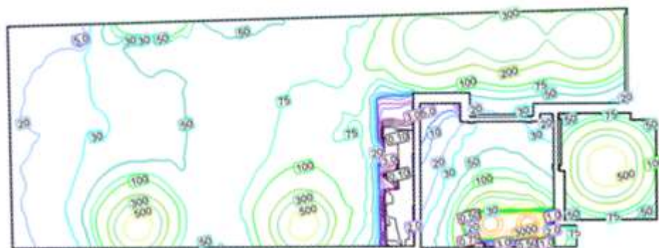
Figura 5.4 - Iluminância proposta, assegurada pelo sistema de iluminação artificial do quarto de hóspedes.
