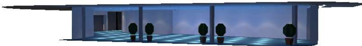
Figura 5.20 - Iluminância do restaurante panorâmico, assegurada pelo sistema de iluminação artificial instalado.
