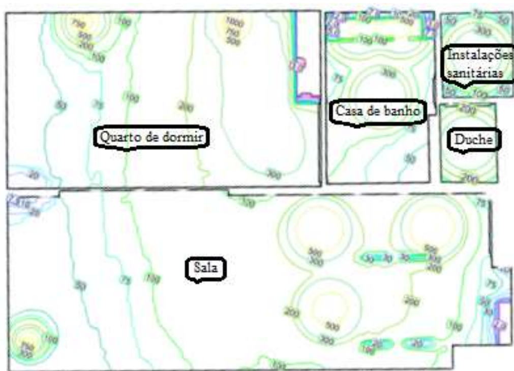
Figura 5.9 - Iluminância instalada para a suite 503, assegurada pelo sistema de iluminação artificial.
