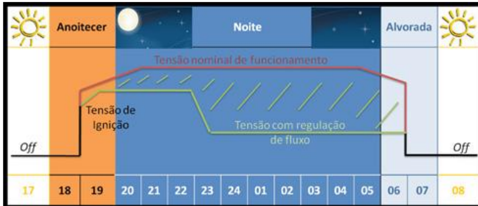
Figura 3-3 – Funcionamento de um regulador de fluxo. [15]
