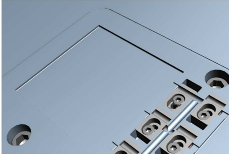
Figura 3-9: Pormenor de versões para os canais de injeção do molde para produção das placas.
