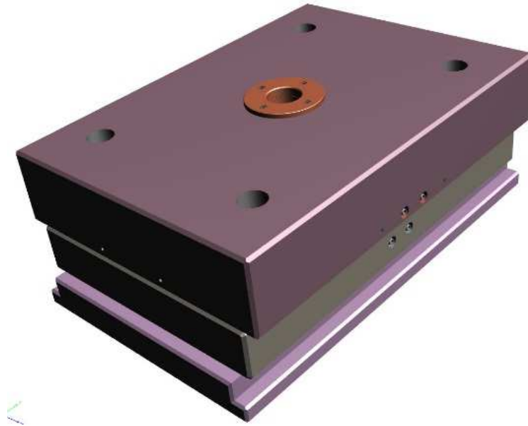
Figura 3-3: 3D do molde para a injeção das placas, vista do lado da injeção.
