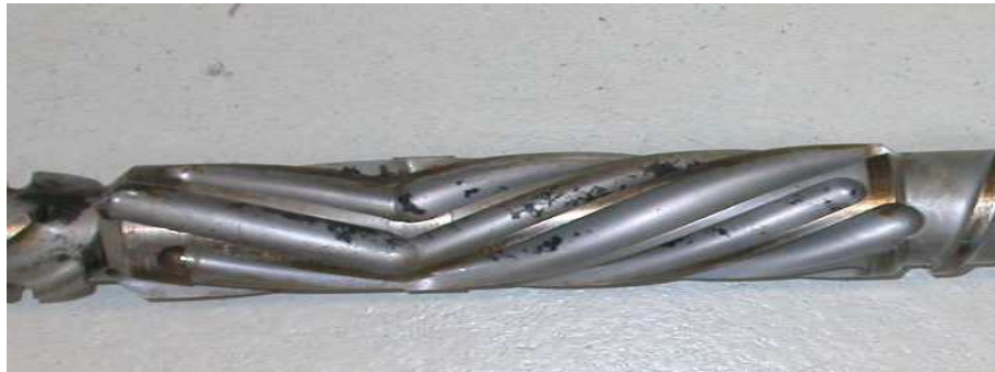
Figura 2-14: Filetes de marcha oposta da haste da válvula antirretorno [11].
