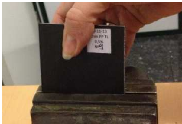
Figura 4-9: Aplicação de carga à placa para se obter o provete.
