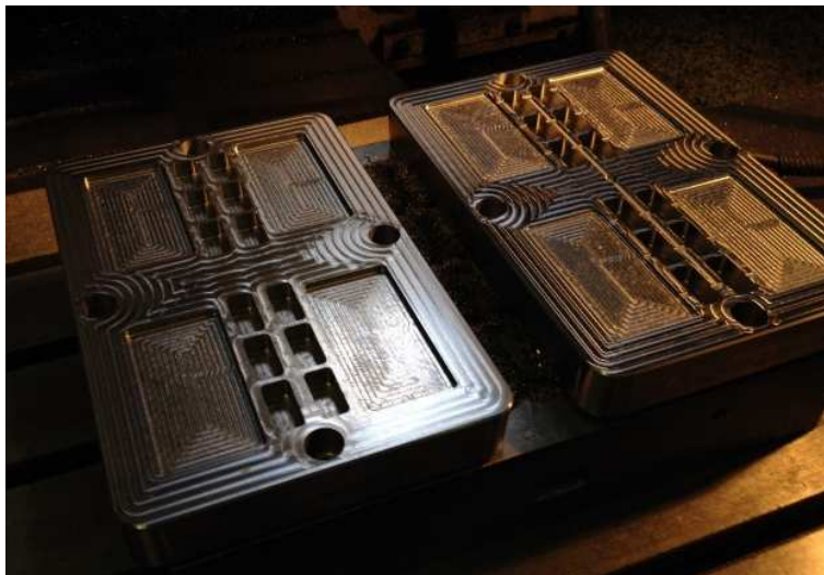
Figura 3-17: Postigos de zonas moldantes da bucha, em aço 1.2738, para molde de injeção das placas.
