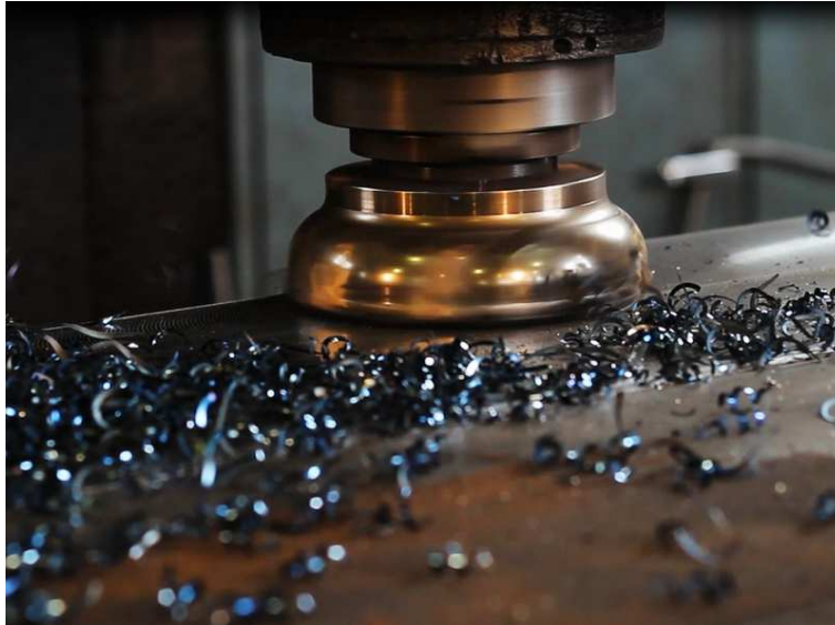
Figura 3-10: Galgamento de uma peça em aço.
