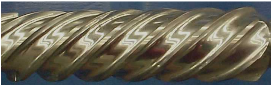
Figura 2-15: Zona de passagem do fuso de injeção [11].
