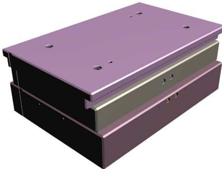
Figura 3-4: 3D do molde para a injeção das placas, vista do lado da cavidade.
