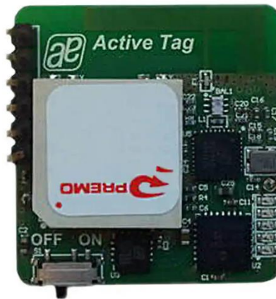
Figura 8 - Exemplo de uma tag RFID ativa presente no mercado
