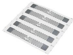
Figura 7 - Exemplo de uma RFID tag passiva
