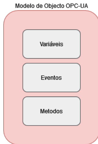
Figura 14 - Modelo do Objeto presente no espaço de endereço de um servidor OPC-UA
