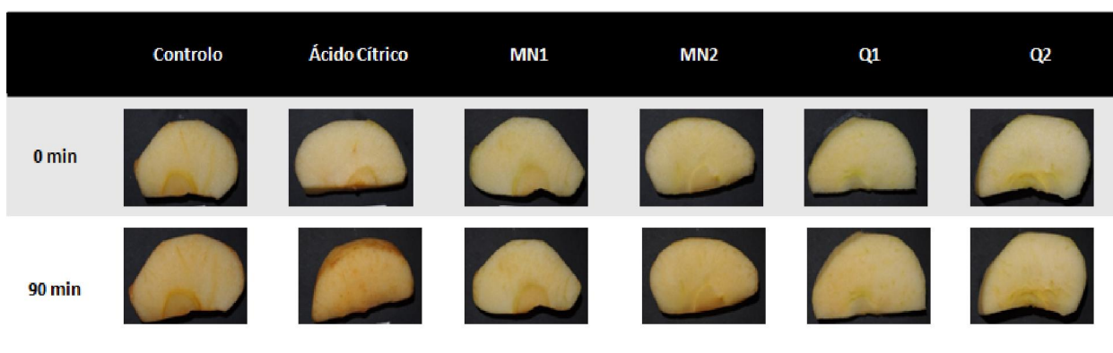
Figura 10. Índice escurecimento das amostras tratadas com as soluções 0,5% de extrato de algas ( Fucus spiralis (MN1), Bifurcaria bifurcata (MN2), Codium tomentosum (Q1) e Codium vermilara (Q2)) ou 0,5% de ácido cítrico ou água (controlo) após 90 minutos de exposição à temperatura ambiente ( 21 \pm 2^\circ\text{C} ), sem proteção da luz. Valores correspondem à média \pm desvio padrão ( n=3 ). * Diferenças estatisticamente significativas em relação ao controlo ( p<0,05 , ANOVA, teste Dunnett ).
