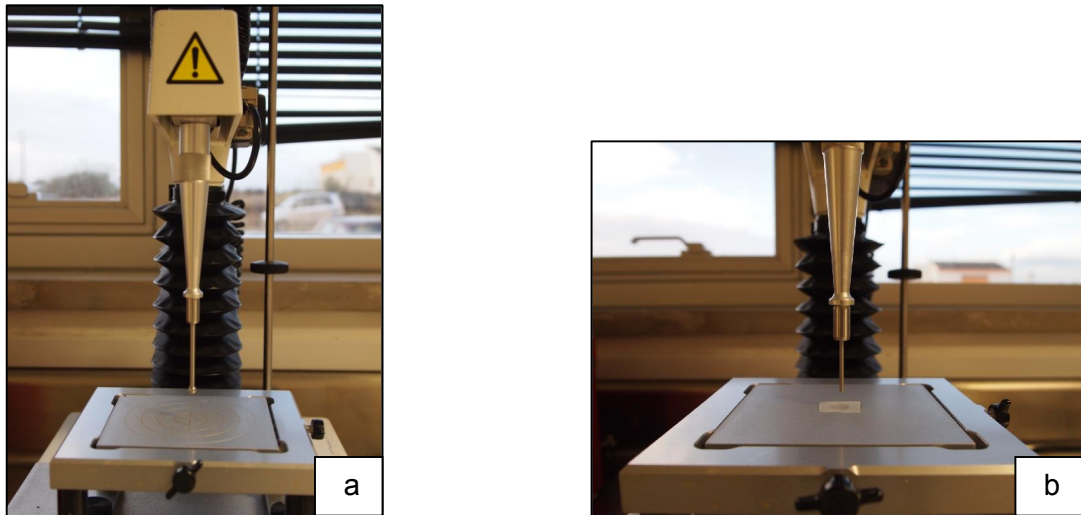
Figura 13. Sondas do texturometro utilizadas nos testes de perfuração de fatias de maçã revestidas (a) e nos testes de tensão dos filmes formulados (b).
