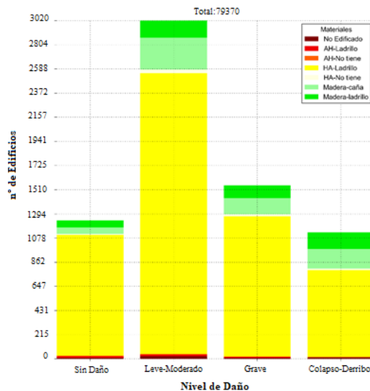
Figura 2.28: Número de edificaciones afectadas en función del grado de daño y material de construcción. Fuente: (EPN, 2017)
