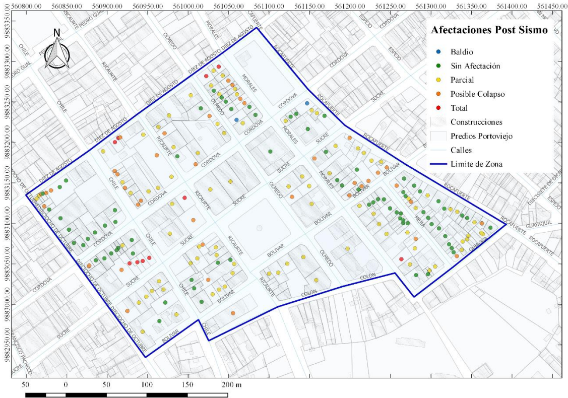
Figura 4.4: Evaluación de daños por efectos del sismo del 16 de abril del 2016, en la zona de estudio.
