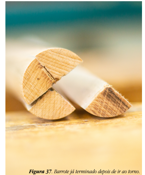
Figura 37. Barrote já terminado depois de ir ao torno.
