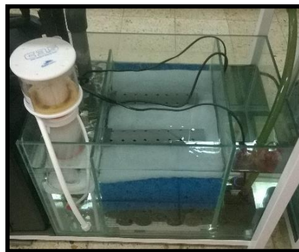
Figura 2.1 - Sistema de recirculação utilizado para a realização do trabalho experimental (a) e respetivo sistema RAS (b). Autor: Marcela França.
