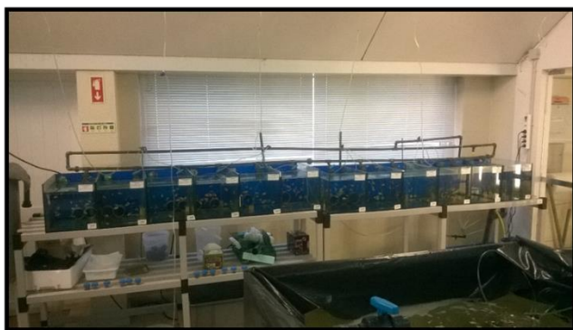
Figura 2.1 - Sistema de recirculação utilizado para a realização do trabalho experimental (a) e respetivo sistema RAS (b). Autor: Marcela França.
