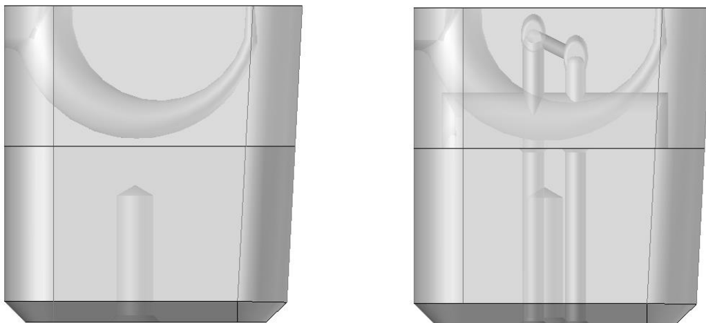
Figura 70: Vistas laterais do modelo híbrido original (à esquerda) e modelo híbrido topologicamente otimizado (à direita).
