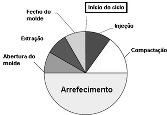
Figura 2: Ciclo de injeção “adaptado de (Goodship, 2004)”.
