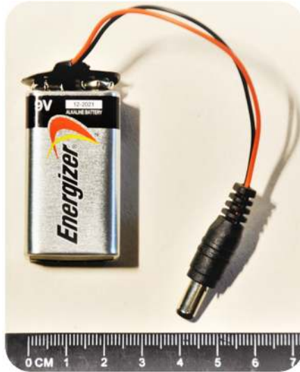
Figura 4.3 - Fonte de alimentação interna
