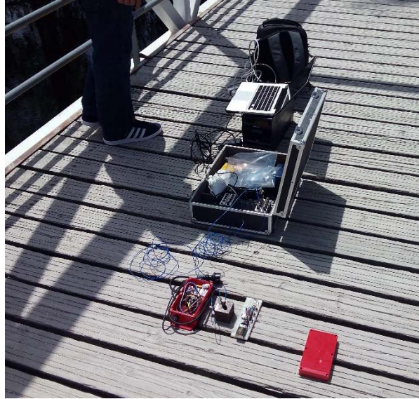
Figura 7.5 - Dispositivo 2 (esq.), Dispositivo Padrão (centro) sobre a ponte pedonal
