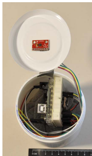
Figura 5.2 - Embalagem com o Dispositivo 1 e diafragma com sensor
