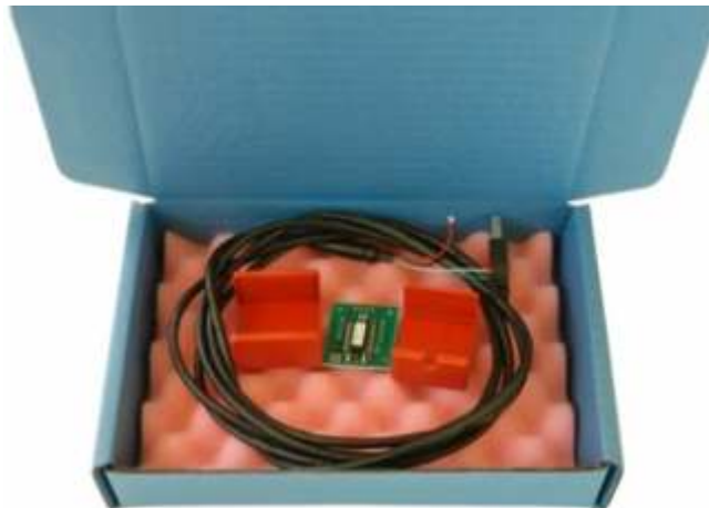
Figura 4.16 - Solução COTS da Joy Warrior, dispositivo de aquisição de vibrações
