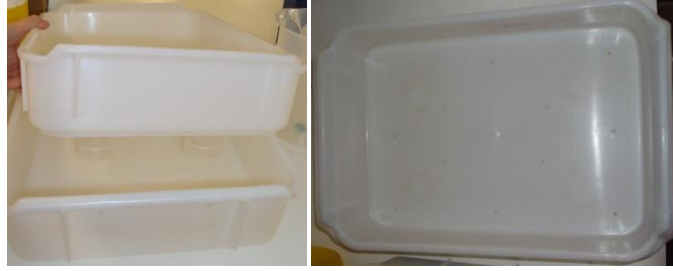
Figura 6 – Tabuleiros com sistema de drenagem de água (Fonte própria).
