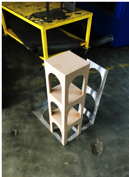
Figura 168. 169. 170. 171. 172. Corte da placa MDF Hidrófugo Colorido, meia esquadria, colagem (cola branca). Torno Mecânico. Corte a Laser e Quinadeira de chapa, União (Soldadura), Lacagem
