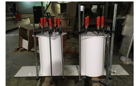
Figura 207. 208. 209. 210. 211. 212. 213. 214. Corte (Esquadrejadora) e União (Cola Específica) de diferentes superfícies em Corian (planas e curvas / retangulares e circulares)
