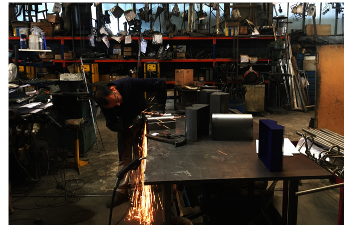
Figura 99. Acabamento das peças ao Rebarbar as mesmas com diferentes gramagens; Lacagem
