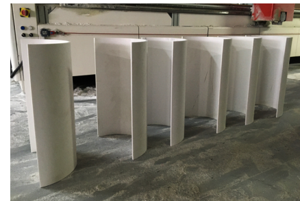
Figura 207. 208. 209. 210. 211. 212. 213. 214. Corte (Esquadrejadora) e União (Cola Específica) de diferentes superfícies em Corian (planas e curvas / retangulares e circulares)
