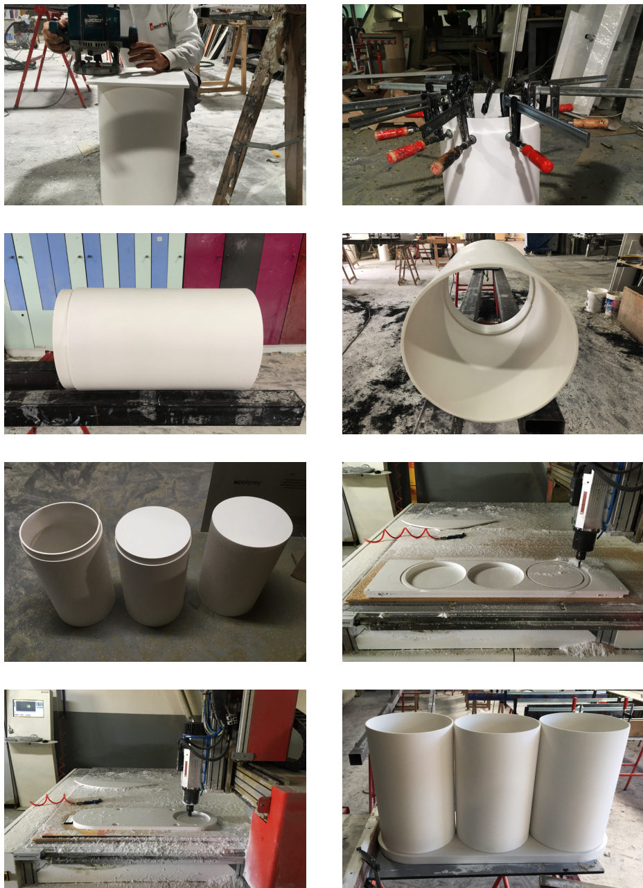
Figura 215. 216. 217. 218. 219. 220. 221. 222. Corte da Placa em Corian através de CNC. Acabamento das peças com recurso à Lixadora Rotorbital, com diferentes gramagens
