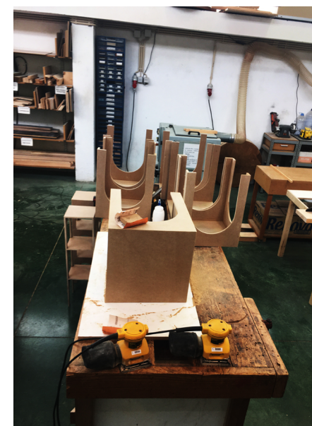
Figura 155. 156. 157. 158. 159. 160. Corte de placa MDF à Meia Esquadria (Esquadrijadora); Corte do arco em CNC; Colagem (cola branca)
