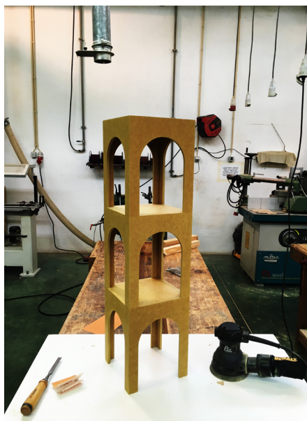
Figura 161. 162. 163. 164. 165. 166. Corte da placa MDF Hidrófugo Colorido, Meia Esquadria, Corte do arco em CNC (com uma placa de fixação) e posterior Colagem (cola branca)
