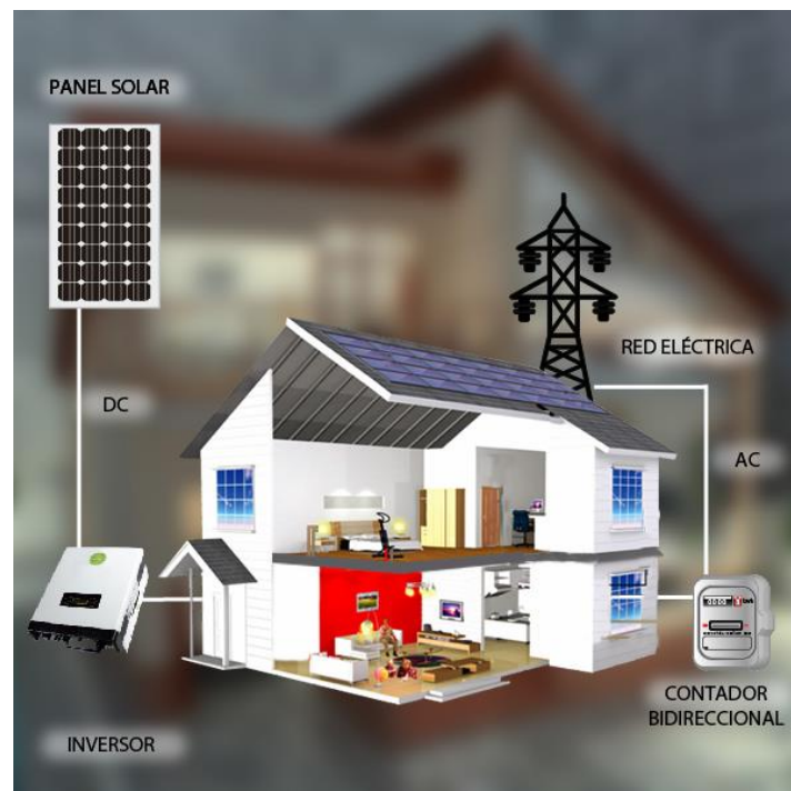
Figura 10 - Sistema fotovoltaico interconectado a la red eléctrica 10 .
