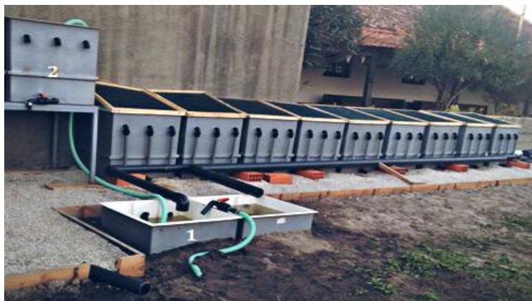
Figura 12- Desenho experimental para o ensaio de crescimento. Número 1- Refere-se ao depósito 1; Número 2- Refere-se ao tanque de cabeça (Fonte: Própria).
