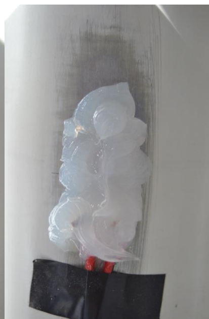
Figura 63 – Extensómetro soldado e protegido
