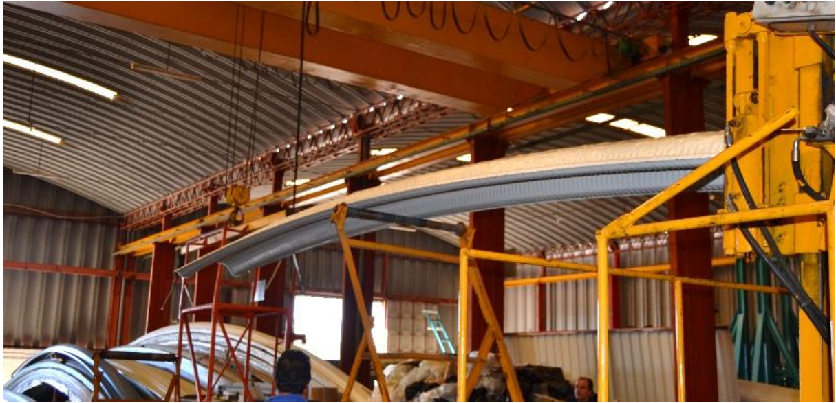
Figura 19 - Curvatura devida ao peso próprio
