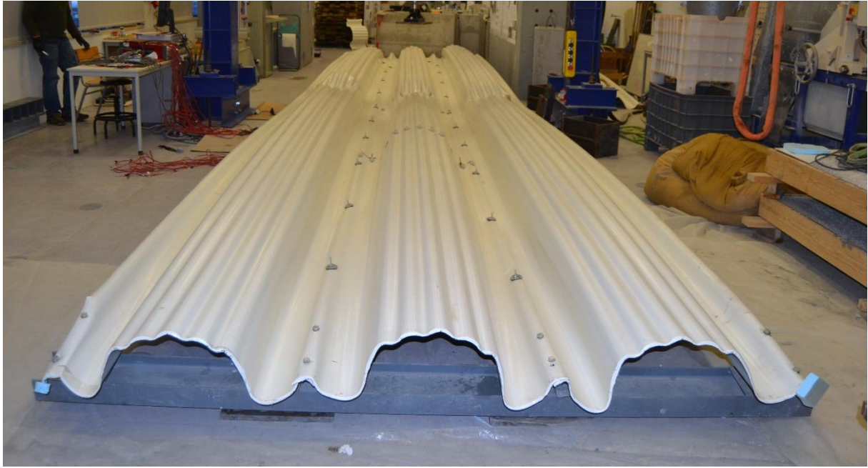
Figura 82 – Estrutura após a rotura
