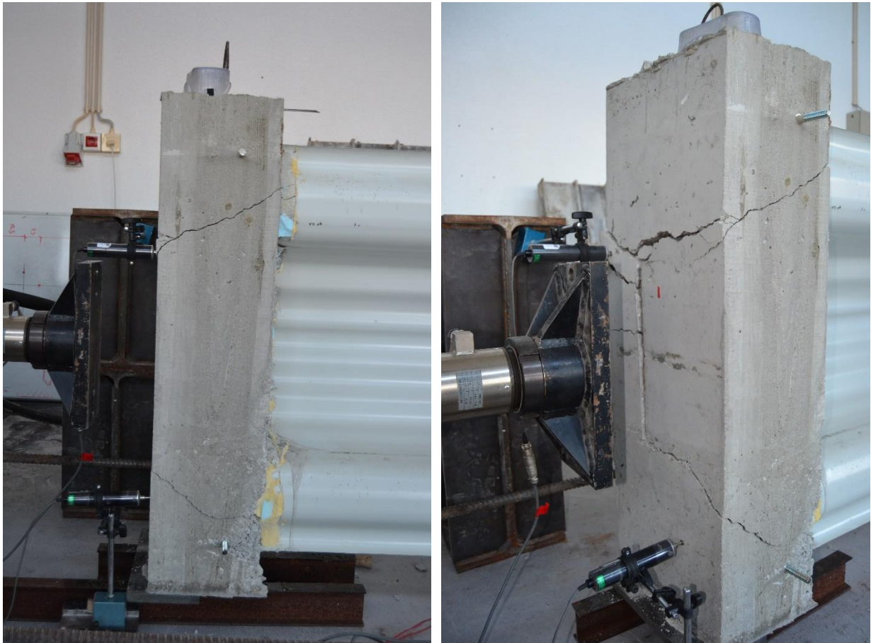
Figura 42 – Rotura do bloco de betão por punção
