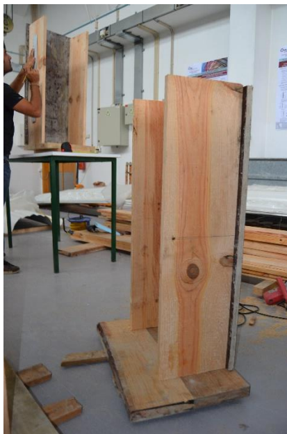
Figura 31 – Cofragem exterior em madeira
