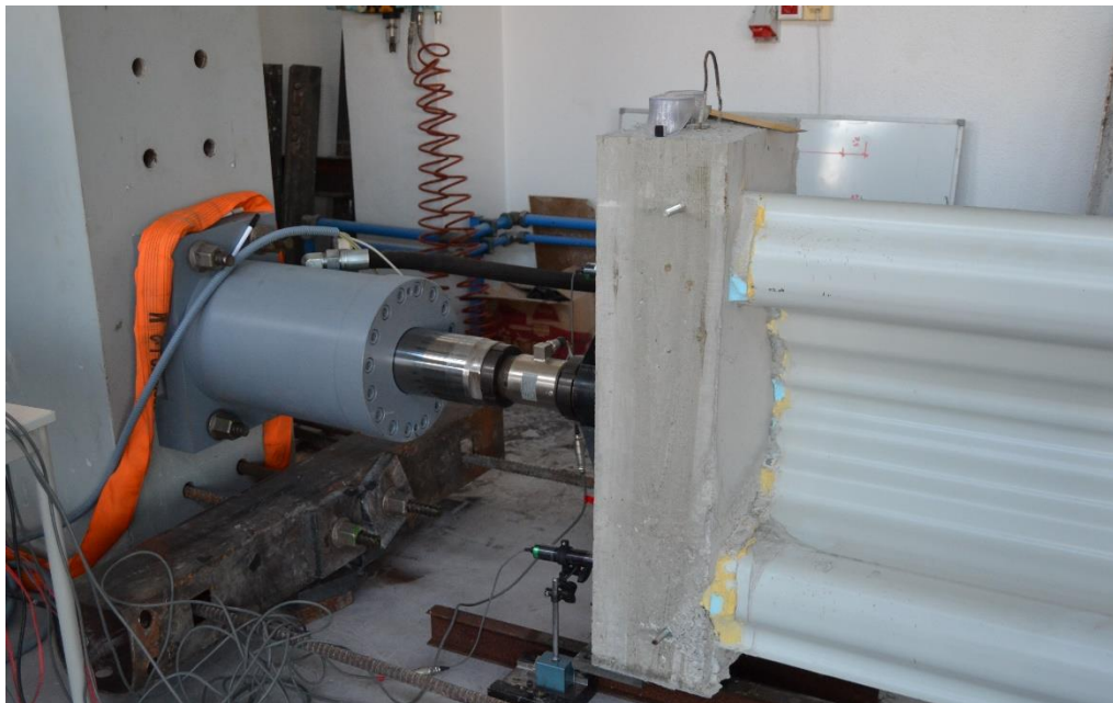
Figura 40 – Colocação do atuador na parede de carregamento
