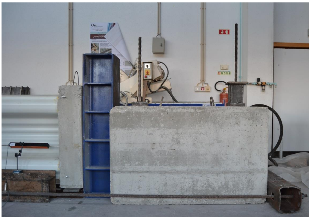
Figura 41 – Colocação do bloco de reação
