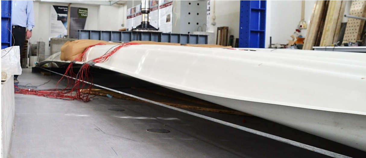
Figura 75 – Deformação longitudinal do conjunto
