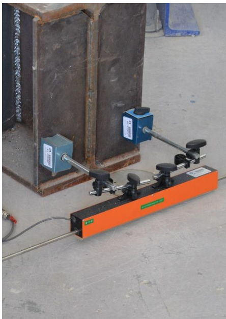
Figura 65 – Transdutor de deslocamentos SDP-300D
