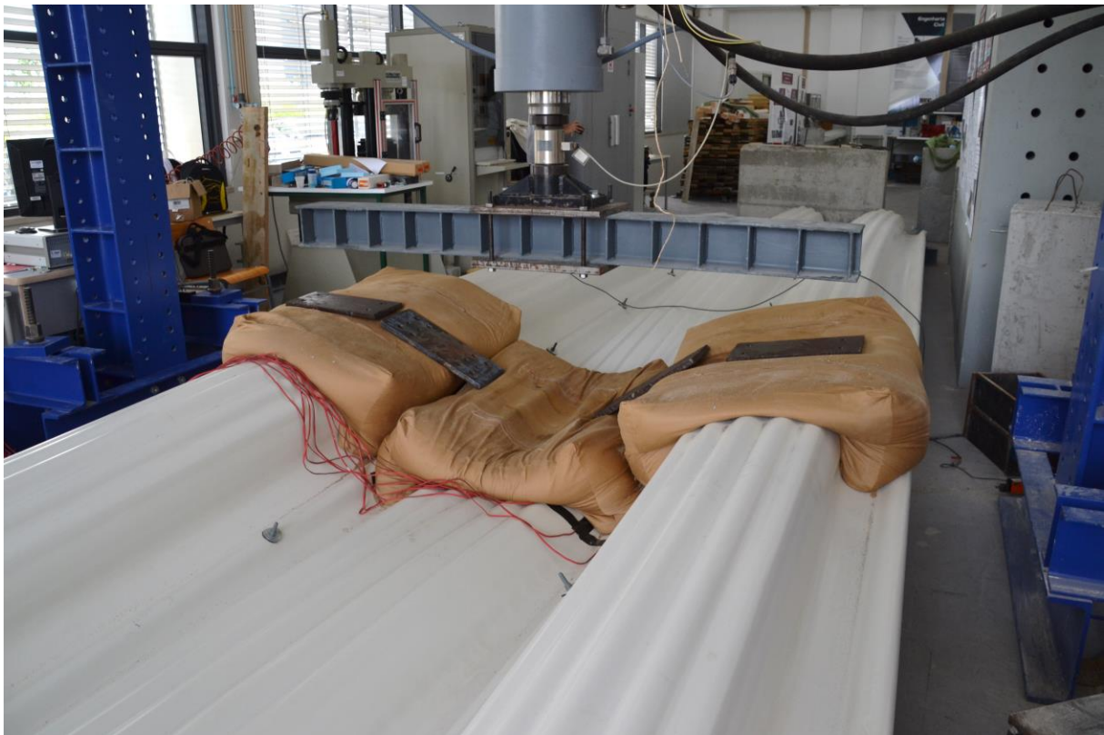
Figura 76 – Colapso da telha central (Vista superior)
