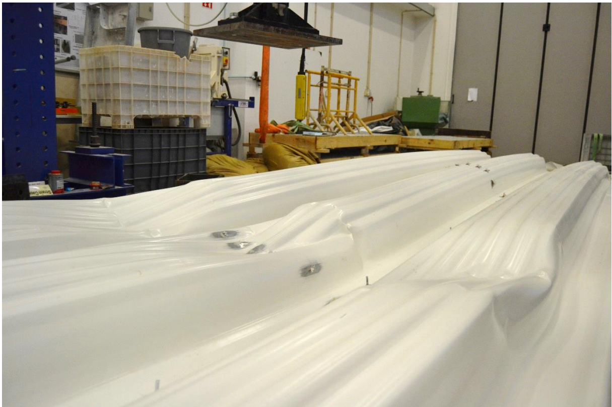
Figura 83 – Estrutura após a rotura (Vista alternativa)
