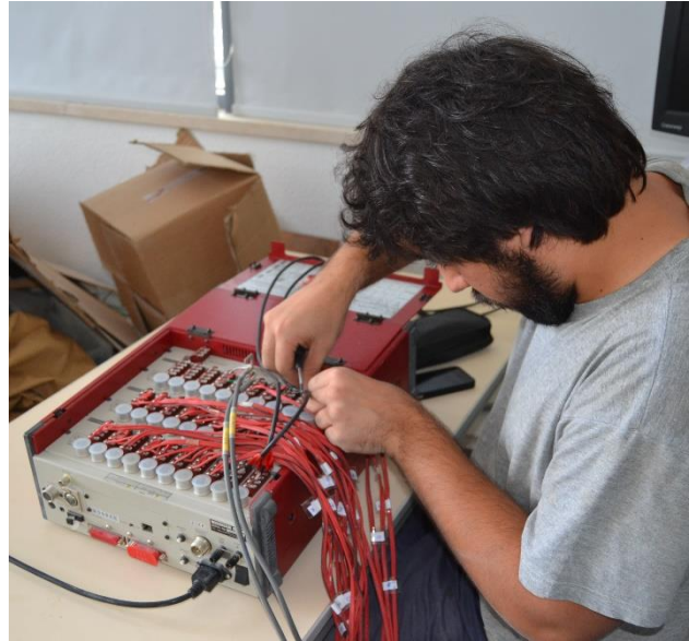
Figura 69 – Data Logger TDS-303 com toda a instrumentação ligada
