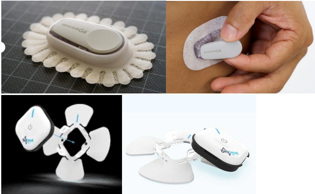
Figura 3. Exemplo de método de encaixe de sensor no suporte para colocação no peito ou omoplata do utente.
