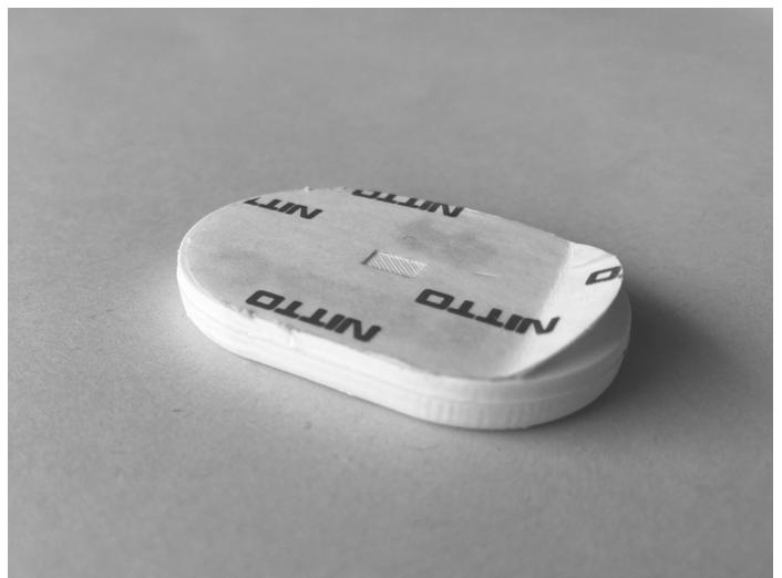
Figura 42 . Teste de destacável para ajudar na remoção do adesivo da cápsula do sensor.
