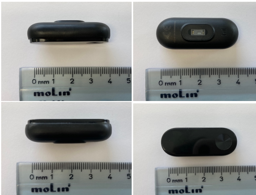
Figura 6. Exemplo de dispositivo que faz leitura corporal, com forma simplificada e ergonómica sem orifícios nem reentrâncias, para permitir uma correta higienização.
