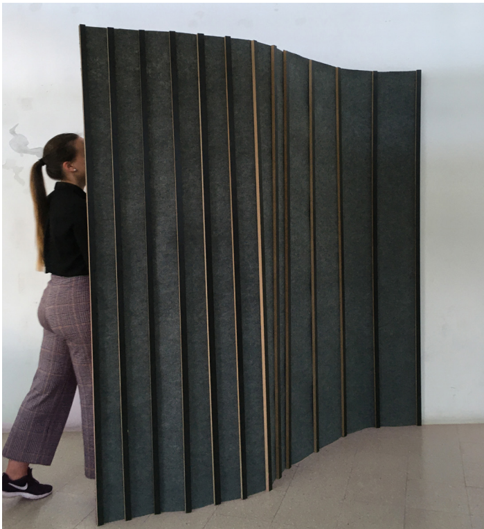
Imagem 122 | Maquete de experimentação à escala real, com inspiração nas experiências iniciais de tecido e madeira. Revelou-se bastante promissora na componente de funcionamento e visualização do projeto. Maquete desenvolvida com recurso a madeira e alcatifa industrial
