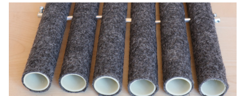
Imagem 131 | Maquete produzida pelo desenho do modelo E com união entre tubos de cabo de aço
