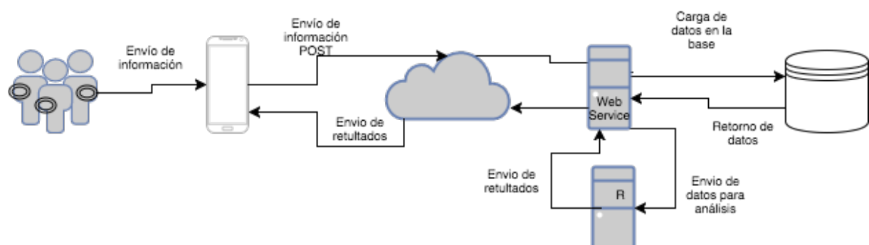
Figura 21 Arquitectura de la solución . Elaboración propia
