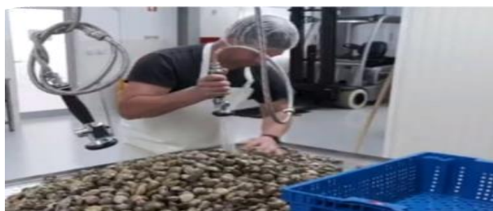
Figura 83 - Lavagem de moluscos bivalves na depuradora. (Adaptado Aquanostra)
