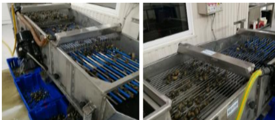
Figura 88 - Processo da triagem mecânica na depuradora, realizada com o auxílio do triador automático (imagens do próprio)
