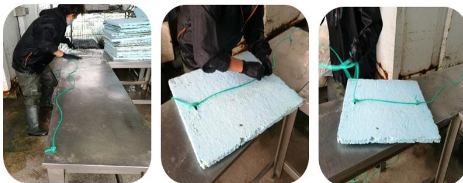
Figura 51 - Colocação da corda principal do sistema vaivém (imagens do próprio)
