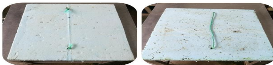
Figura 50 - Placas de esferovite com suportes para os sistemas de ganchos dos sacos ostrícolas (imagens do próprio)
