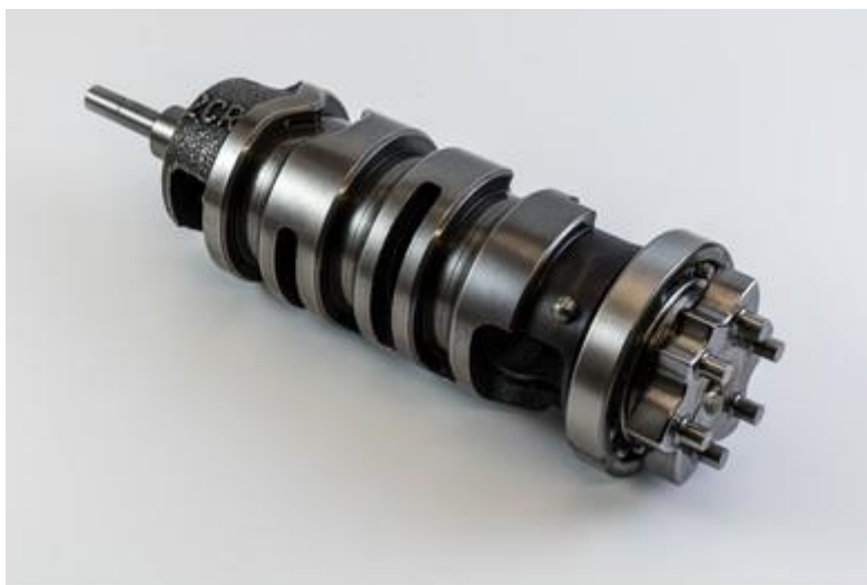
Figura 10 - Tambor de uma caixa de velocidades sequencial (Shift Drum Motorcycle Race Gearbox Foto Stock 752036905 | Shutterstock, n.d.)
