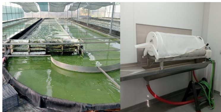
Figura 3.8 – Raceways dentro da estufa e o sistema de colheita e retenção da biomassa húmida.
