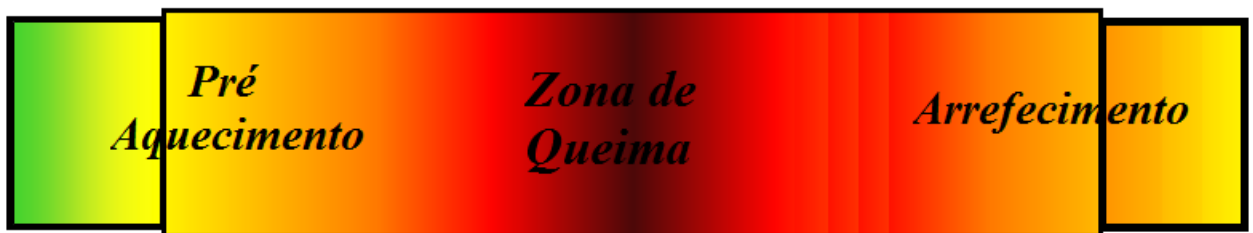
Figura 5: Esquema das temperaturas dentro do Forno Túnel
