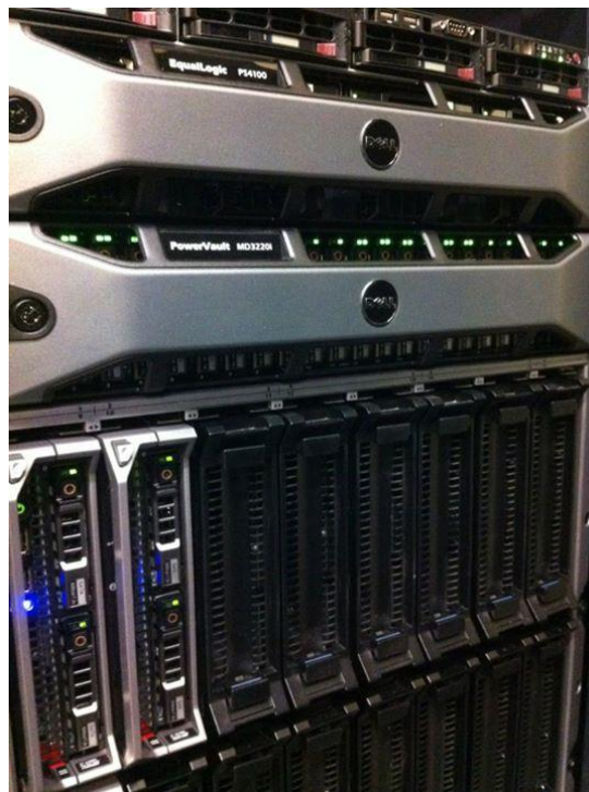
Figura 11 – Hardware de suporte à máquina virtual utilizada: SAN Dell Equallogic e Powervault (cima) e central de processamento composta por servidores Dell Blade (baixo).
