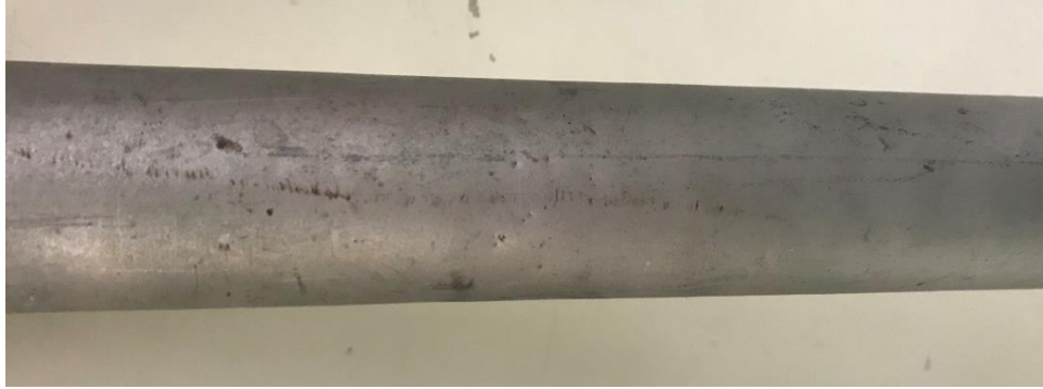
Figura 4.11 – Revestimento spray and fuse
