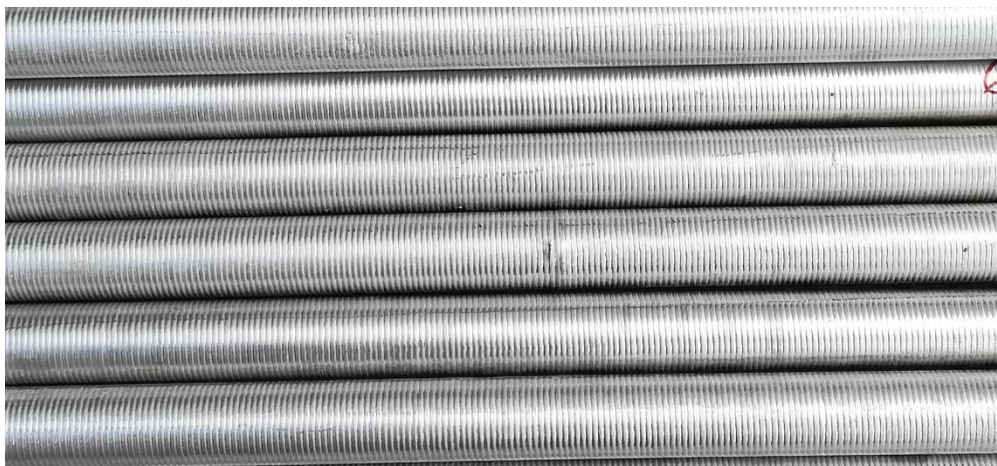
Figura 4.13 – Tubos revestidos com inonel 625 weld overlay
