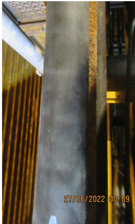
Figura 4.20 – Tubo com 63 meses de operação
