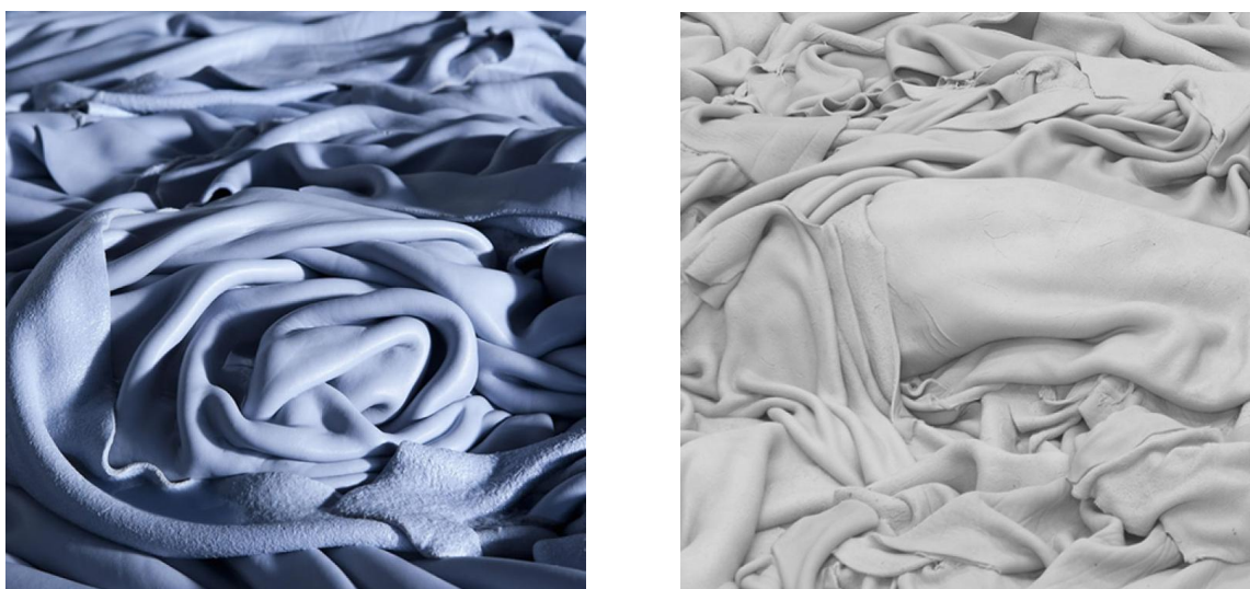
Figura 2.4 – Diferentes tipos de pele (Biocouro, 2025). (esquerda) Pele Wet-Blue (direita) Pele Wet-White
