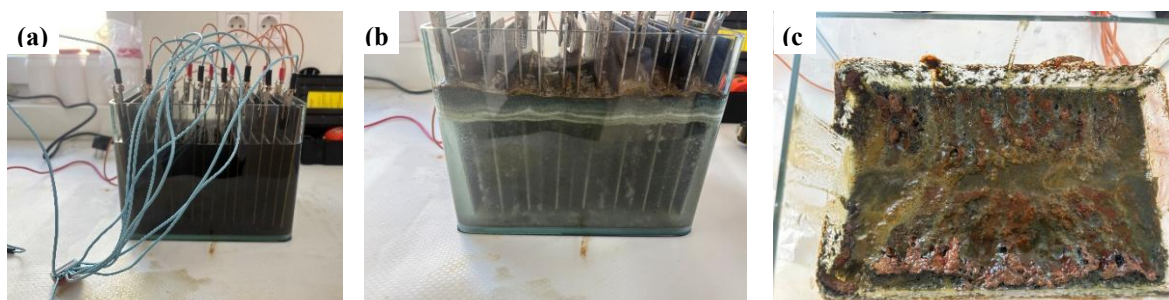
Figura 4.3 - Evolução do processo laboratorial de eletrocoagulação, como exemplo do ensaio de Fe a elevado consumo energético.
