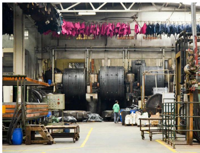
Figura 2.5 - Máquina de tingimento (Melanda, 2020).
