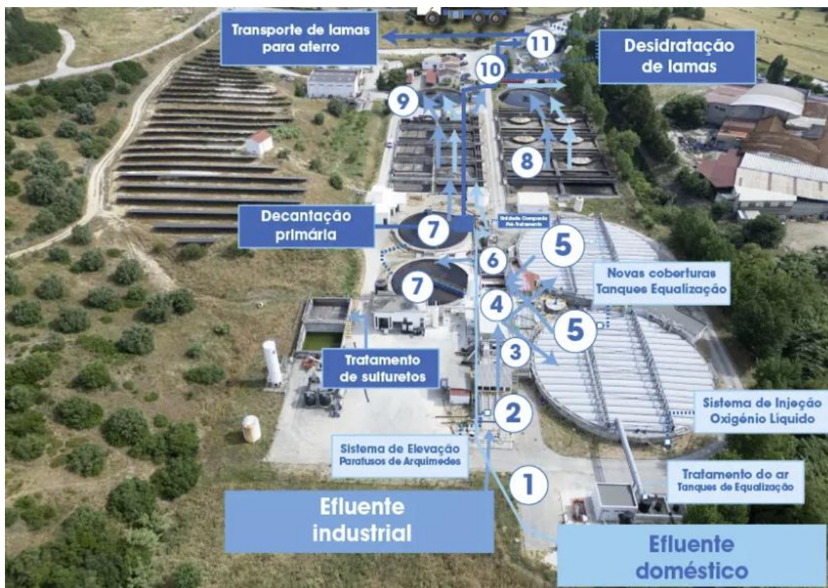
Figura 2.8 - Esquema da ETAR de Alcanena (Aquanena, 2025).
