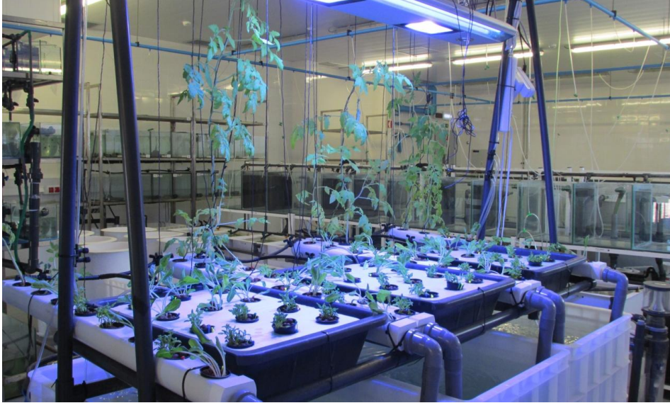
Fig. 6- Sistema aquapónico para crescimento de robalo, acelga e espinafre a salinidade 3 ppt.
