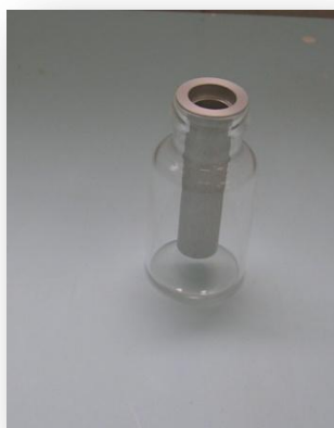
Figura 7.1.9- Colocação do tubo metálico no frasco
