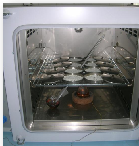
Figura 7.1.7 – Estufa (Hereaus) com as placas contendo aproximadamente 2g de amostra.
