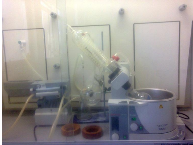
Figura 3.6. Evaporação do clorofórmio no rotavaporador
