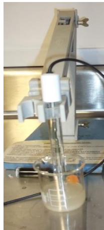
Figura 3.9. Medição do pH por potenciometria.
