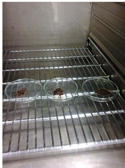
Figura 3.4. Secagem da amostra em estufa
