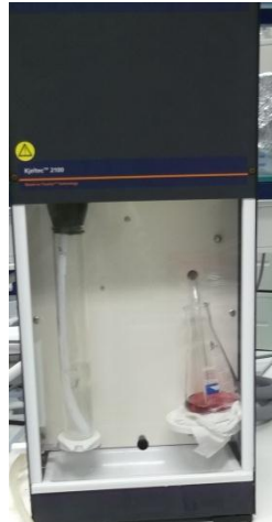
Figura 3.5. Destilação por arrastamento de vapor e recolha do ácido bórico
