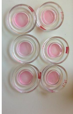
Figura 3.10. Titulação com solução de ácido clorídrico até obtenção da coloração rosa.
