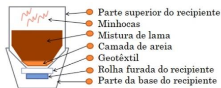
Figura 5 – Esquema do um vermireator preparado para este estudo.
