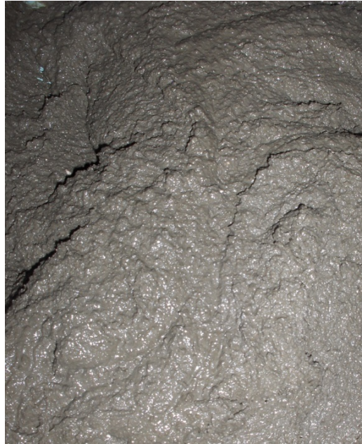
Figura 18 - Argamassa com resina epóxi misturada.
