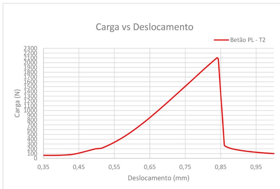
Figura 26 – Ensaio à flexão do betão convencional hidratado dentro de água.
