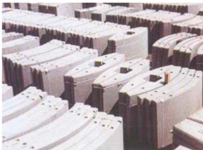
Figura 14 – Segmentos de tuneis em betão reforçado com fibras de aço [25].
