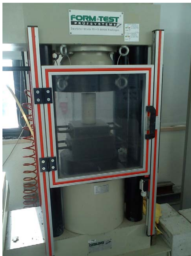
Figura 28: Equipamento de ensaio compressão com provete pronto para ensaio.
