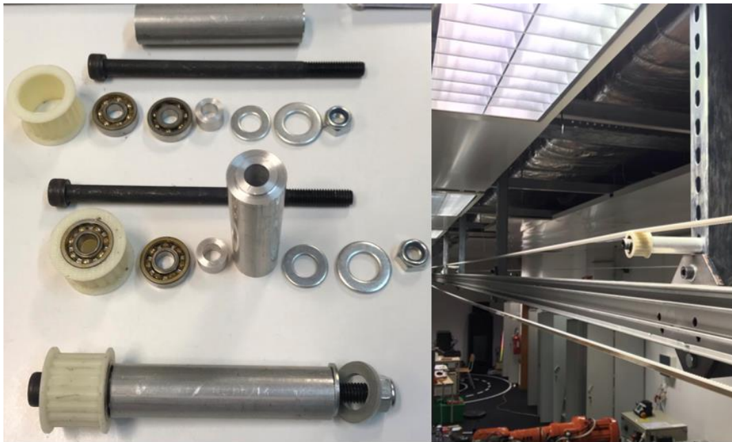
Figura 4.21 - À esquerda: três apoios da correia em etapas diferentes de montagem. À direita: montagem de um apoio da correia.
