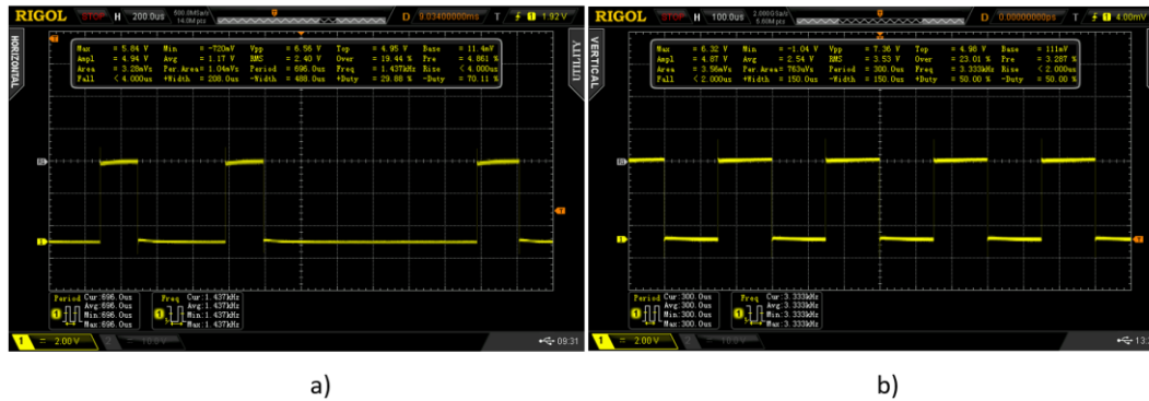
Figura 4.36 - a) Sinal STEP gerado com função delay , verificando-se o impacto do processamento do microprocessador na geração do sinal. b) Sinal STEP gerado com função timer.pwm , não apresentando impacto da computação na geração do sinal.
