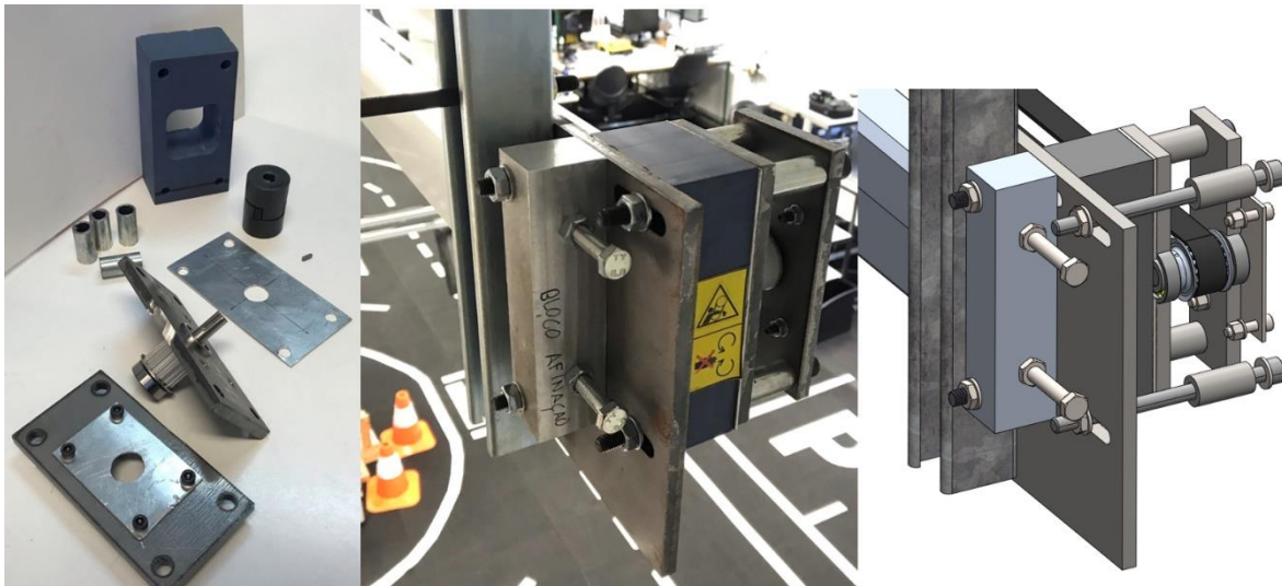
Figura 4.20 - Fotografia das peças para montagem da chumaceira do veio motor à esquerda. Fotografia da montagem da chumaceira do veio movido ao centro. Modelação do conjunto de chumaceira do veio movido, com corte de alguns componentes, à direita.
