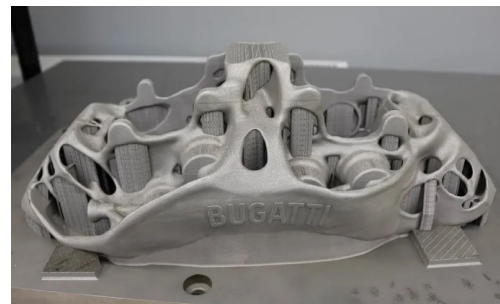
Figura 7: Pinça de travões do Bugatti Chiron fabricada em SLM para facilitar a dissipação de calor e redução de peso. (SLM Solutions, 2019).
