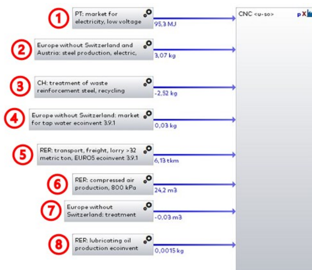
Figura 24: Modelação do AICV no GaBi da produção CNC do CE1.
