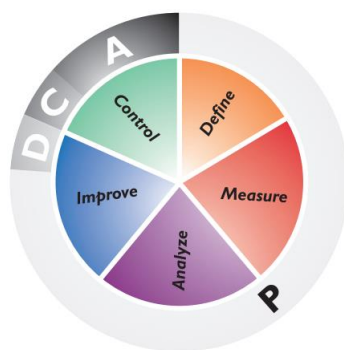
Figura 11 - Correspondência entre o método DMAIC e o ciclo PDCA (Werkema, 2012)
