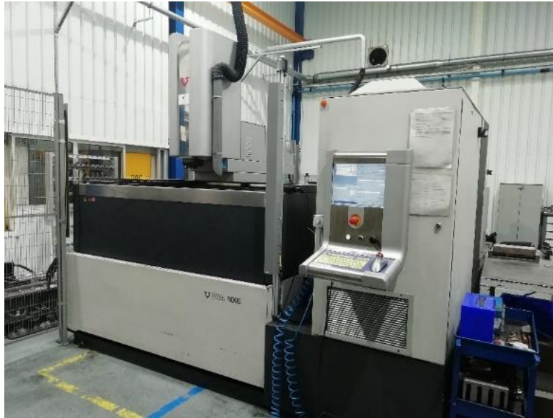
Figura 3.6 - Máquina EDM do fabricante ONA, modelo NX6
