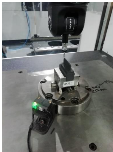
Figura 3.4 - Medição da geometria de referência do Eléctrodo-Rib
