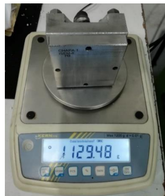
Figura 3.8 – Balança digital Kern, limite 1200 g, precisão 0,01 g
