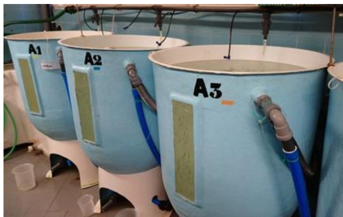
Figura 1. Sistemas de cultivo larvar da Estação Piloto de Piscicultura de Olhão, onde se realizou o ensaio de nutrição com as pós-larvas de robalo, Dicentrarchus labrax , (volume dos tanques 300L).
