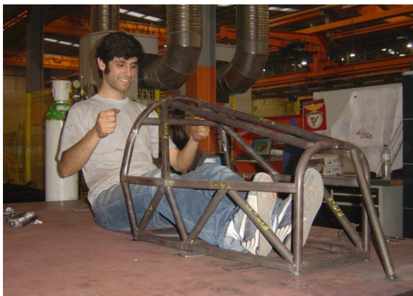
Figura 65 – Construção do chassis com aço AISI 4130.
