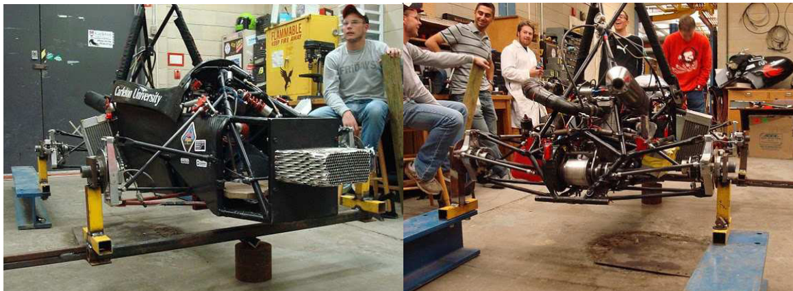
Figura 20 – Chassis montado na mestra para teste de rigidez torsional, Universidade de Carleton ( http://ravensracing.com/ ).
