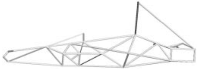
Figura 23 – Exemplo de chassi tubular utilizando triangulações (Adams, 1993).
