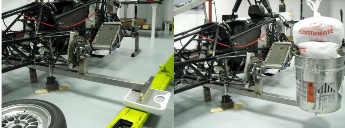
Figura 75 – Aplicação das forças nos estes de rigidez torsional.
