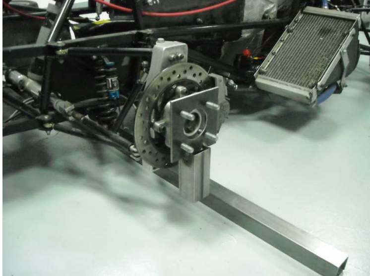
Figura 71 – Preparação do apoio frontal esquerdo para a soldadura.
