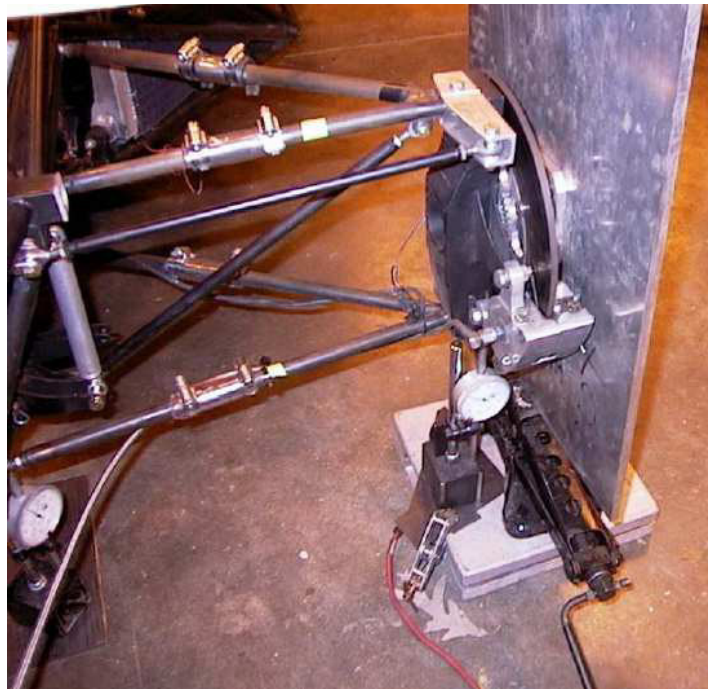
Figura 18 – Teste de rigidez torsional, Universidade de Cornell (Riley e George, 2002).
