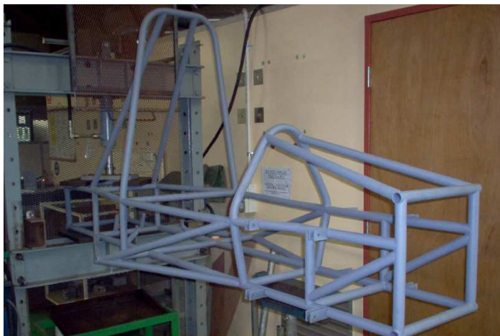
Figura 13 – Exemplo do teste de rigidez torsional da Universidade de Queensland (Baker, 2004).
