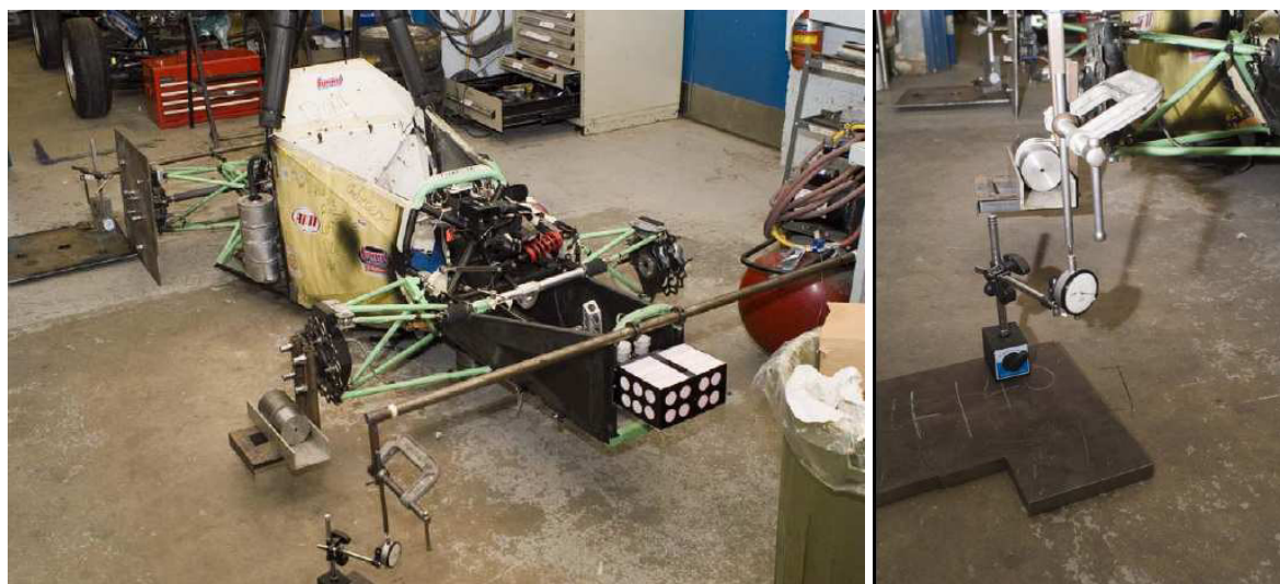
Figura 17 – Teste de rigidez torsional, Universidade de Toronto (Lafreniere, 2007).
