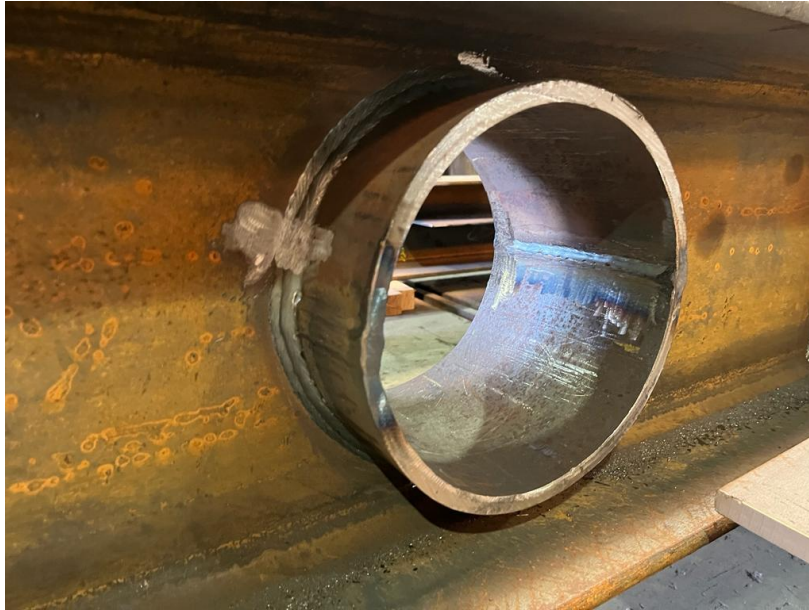
Figura 39 – Tubo CHS 273x12 para Reforço Circular, Soldado em Fábrica (Fonte: Fábrica Bysteel, 2023)
