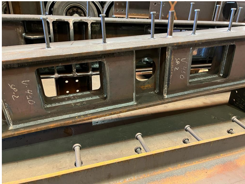
Figura 41 – Chapas para Reforço Retangular, Soldadas em Fábrica (Fonte: Fábrica Bysteel, 2023)
