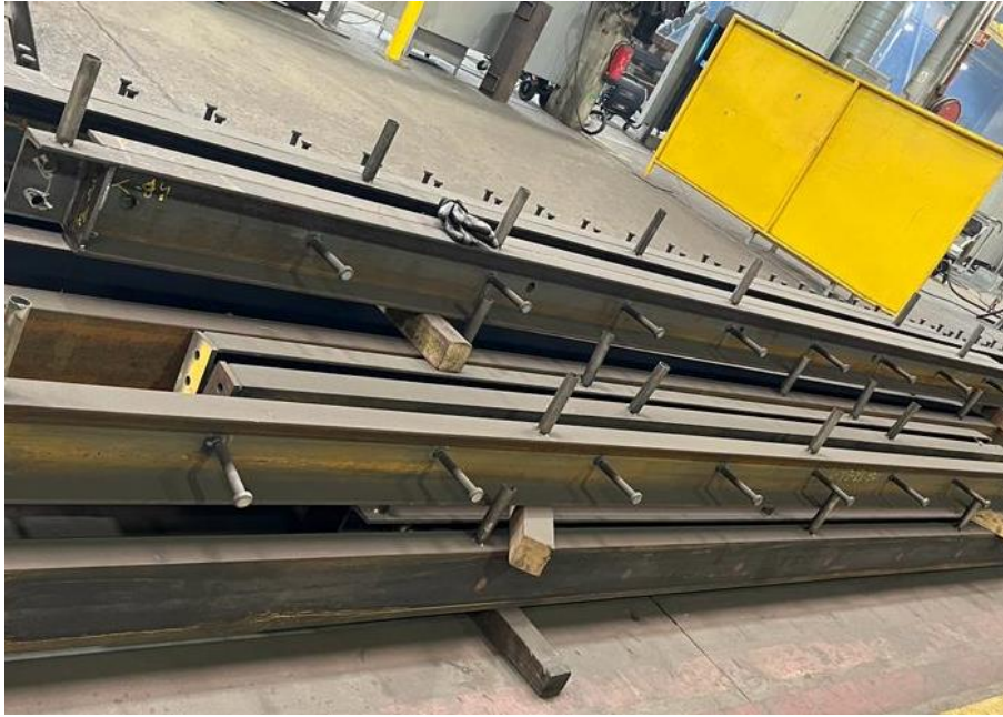
Figura 23 - Conectores Soldados às Vigas (Fonte: Fábrica Bysteel, 2023)
