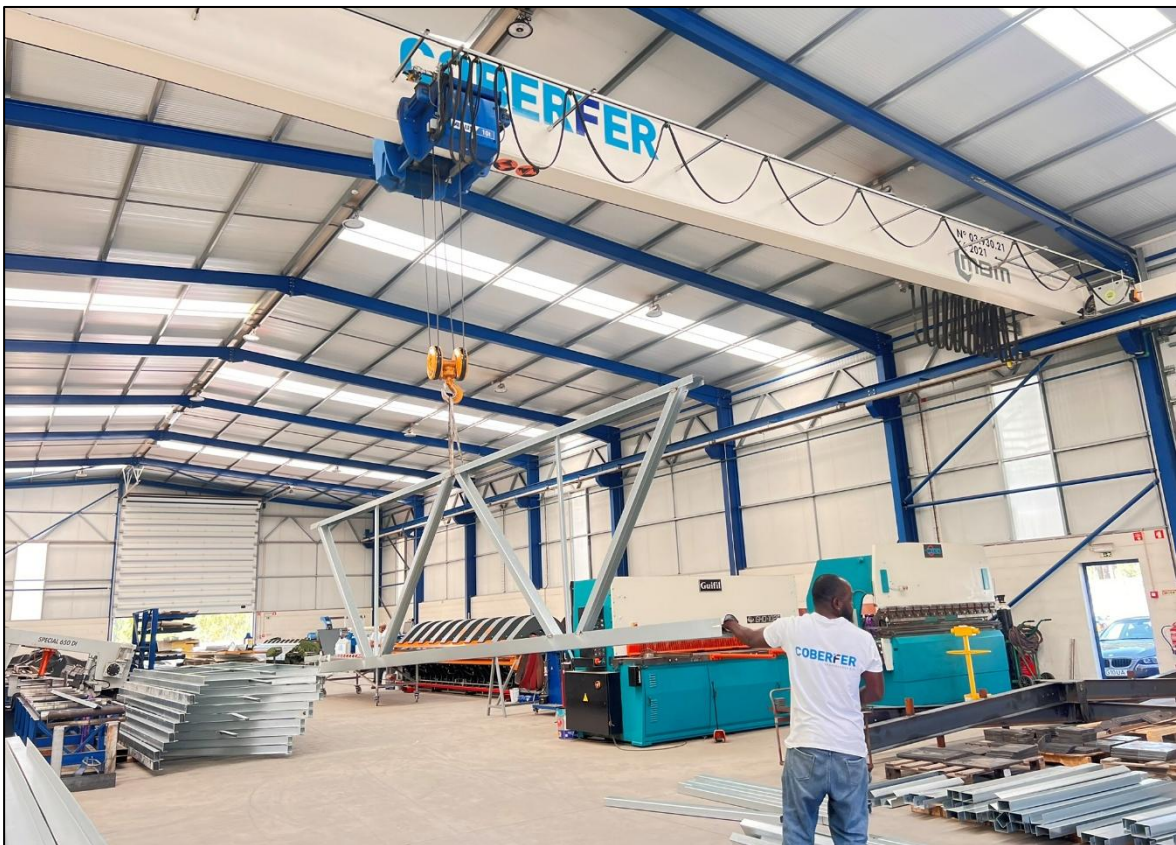
Figura 5.6 – Grua para elevação e posicionamento da treliça da OB. 117-24 (Autor)
