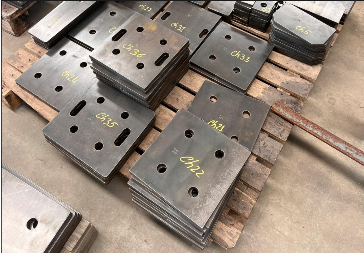
Figura 5.5 – Chapas de aço etiquetadas após corte para identificação posterior (Autor)
