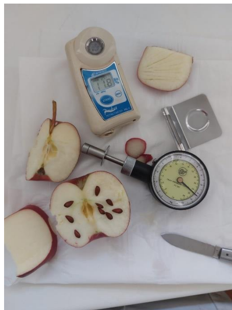
Figura 25. Medição da dureza e determinação da quantidade de sólidos solúveis em maçã
