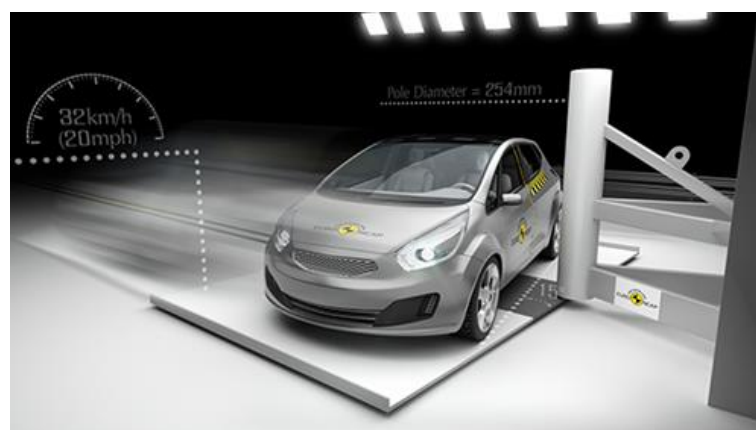
Figura 12 - Teste de impacto lateral por poste (Euro NCAP, s.d.)
