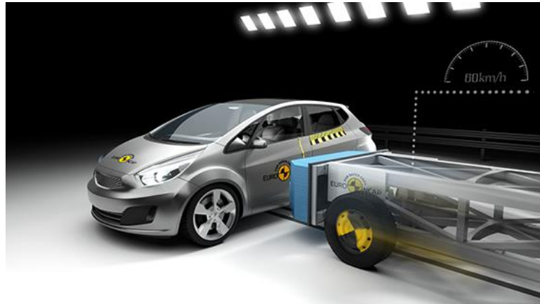
Figura 11 - Teste de impacto lateral por barreira (Euro NCAP, s.d.)
