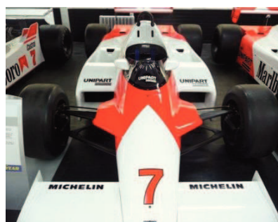
Figura 4 - Chassis do MP4-1 em CFRP e XX Maclaren MP4-1 (A) (Anon., s.d.) (B) (Anon., s.d.)
