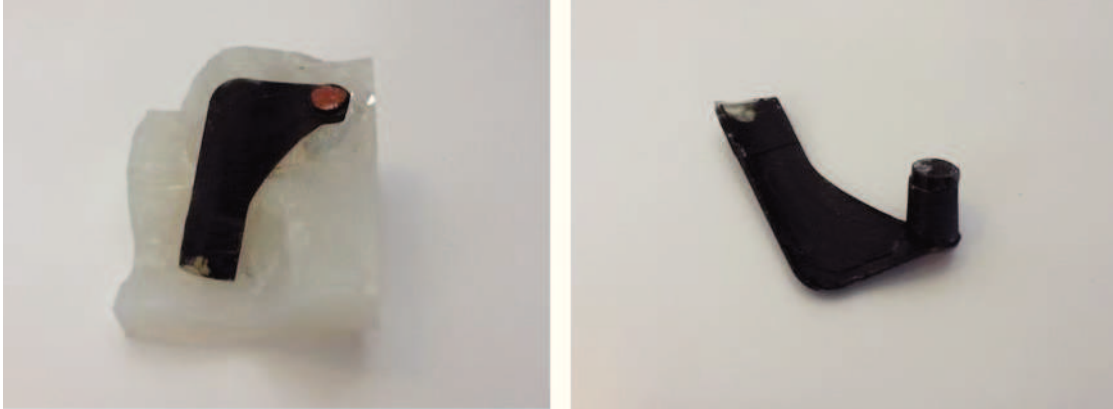
Figura 103 - Modelo da órtese Ergohelp fabricado com fibra de carbono.
