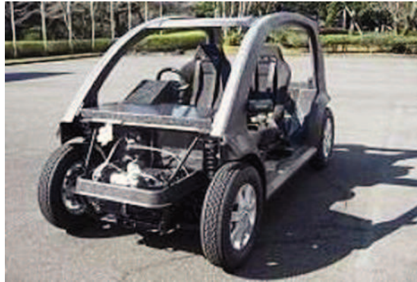
Figura 30 - Chassis de um carro de turismo em CRFP, obtido através moldação por injeção. (tecnológica, 2011)
