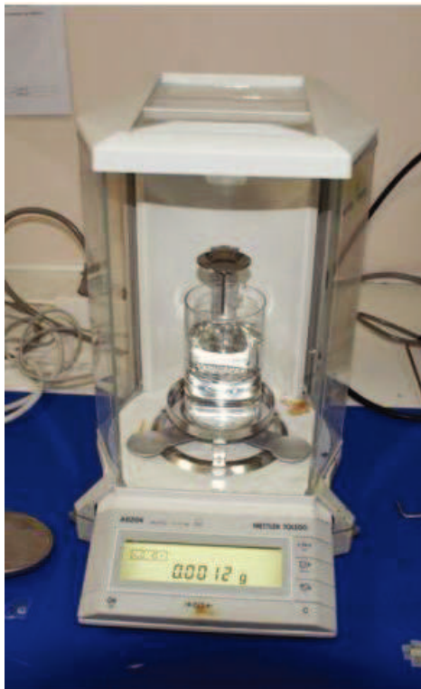
Figura 49 - Balança eletrônica de precisão para a determinação de densidades referencia AG 204 da marca Metter toledo
