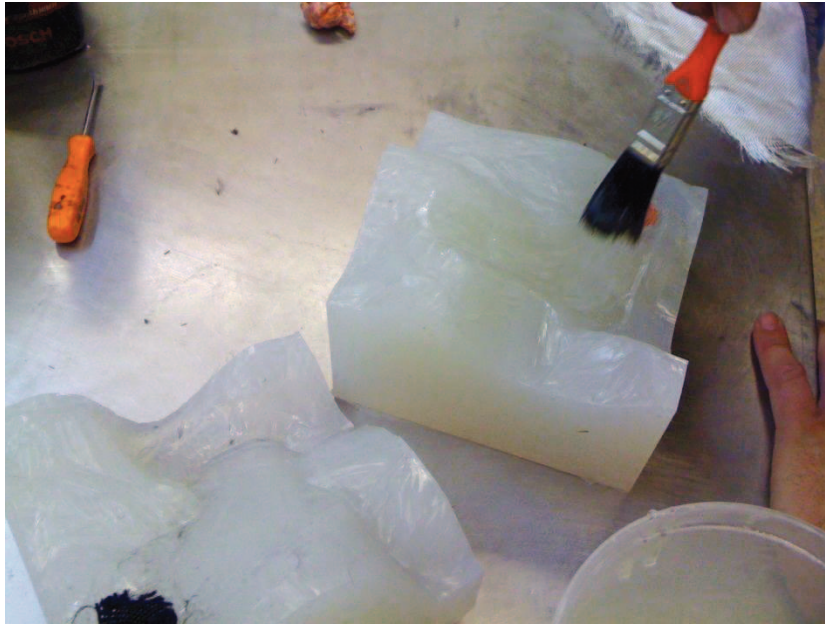
Figura 100 - Aplicação de desmoldante nas superfícies moldantes do molde em silicone utilizado no fabrico da órtese.
