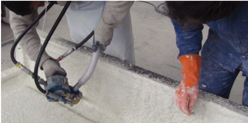
Figura 24 - aplicação da técnica de moldação por projeção. (nodyapi, 2010)
